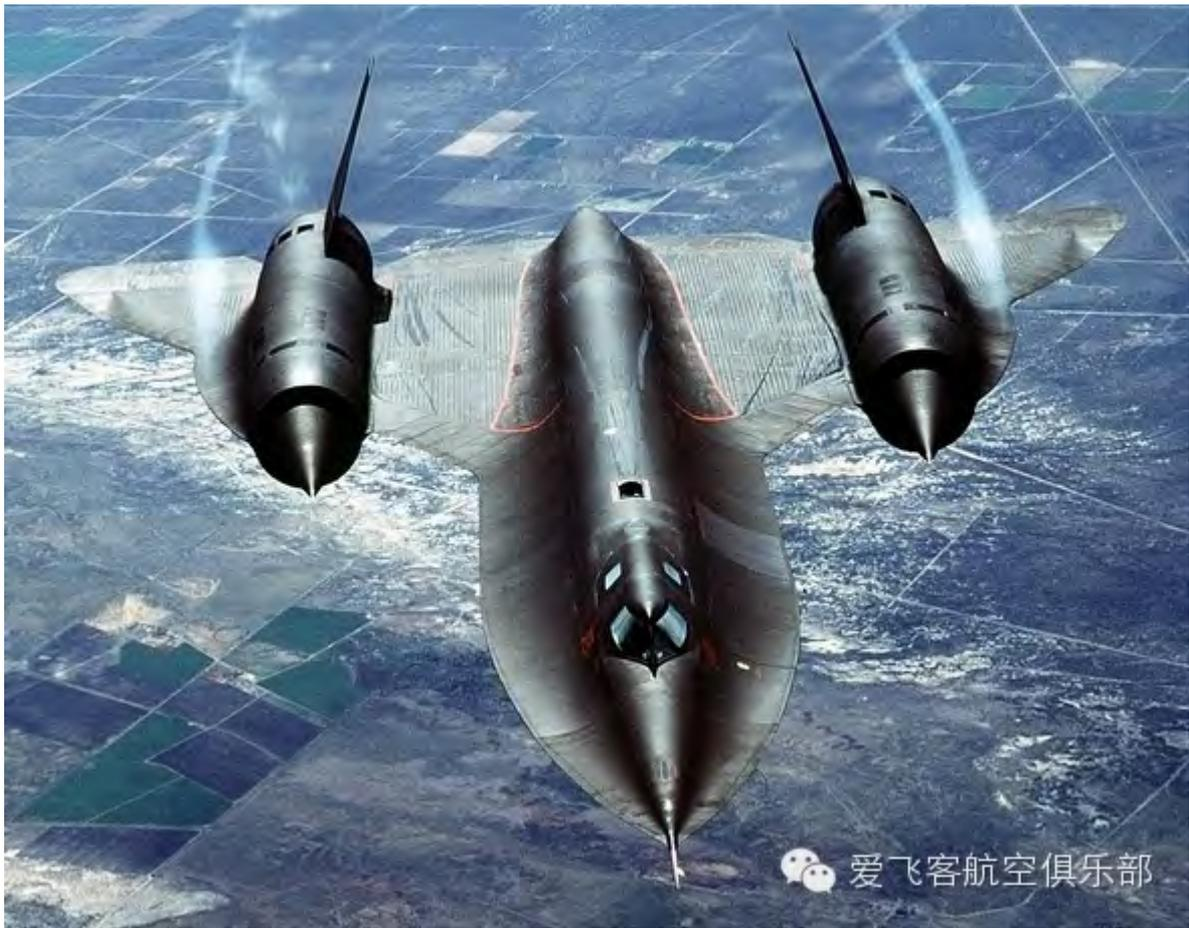
飞机机翼采取向后掠的形式后，又出现了新问题，它比不向后斜的普通机翼，在同样的条件下产生的升力小。飞机起飞时，要滑跑到很大速度，才能使升力等于重量，然后飞机才能离地，跑道要很长，着陆的情况也一样。因此，现代歼击机起飞跑道多在 1000 米以上，重型轰炸机起飞跑道大于 2000 米。所以现代大型机场跑道的长度都要超过 3000 米，战时很容易被敌人破坏。在空中巡航时，后掠翼飞机比普通机翼飞机耗费油料多，航程也会受影响。
