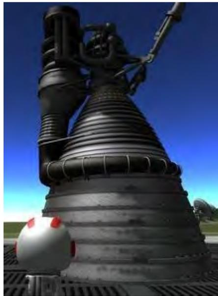
上世纪 50 年代末，整个美国社会陷入“火箭狂热”中，俄罗斯的火箭总是比美国的火箭更大更好，因此，不甘心的美国空军授权加州洛克达因公司 (Rocketdyne) 研制全球最大、功能最强的火箭发动机。最终研制出的发动机名为 F-1，用于“土星 5”号运载火箭的第一级，最终将阿波罗宇宙飞船送上了月球。F-1 是投入使用的推力最大的单喷嘴液体发动机。
