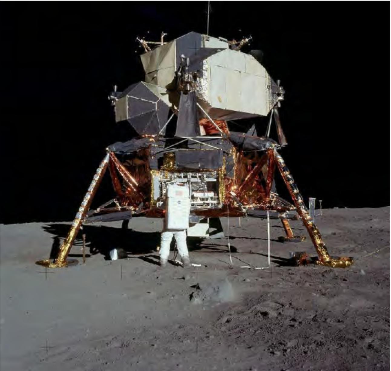
当美国格鲁曼飞机工程公司受命为 NASA 制造阿波罗登月舱（阿波罗宇宙飞船直接登月的部分）时，它们的口号就是让登月舱变得更轻、更轻、更轻。此前，格鲁曼公司一直以制造坚固耐用的战斗机而闻名，现在，它们被要求建造的是真正的航天飞机——只能在太空中飞行的飞机，这就意味着，在普通飞机那大行其道的流线型、空气动力学等都不再管用，他们必须另辟蹊径。他们首先采用的办法是：剔除了很多窗户、座椅甚至侧板，也就是说，凡是对登陆月球没有帮助的所有物品都被摒弃了。
