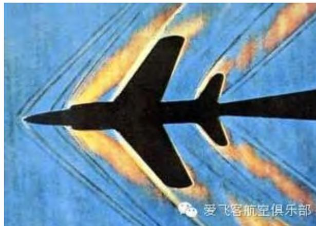
机翼上产生激波后，飞机的阻力会急剧增加，比低空飞行大十倍甚至几十倍，所以即使使用喷气式发动机，也很难使飞机超音速。当时把这种困难叫做“音障”。
