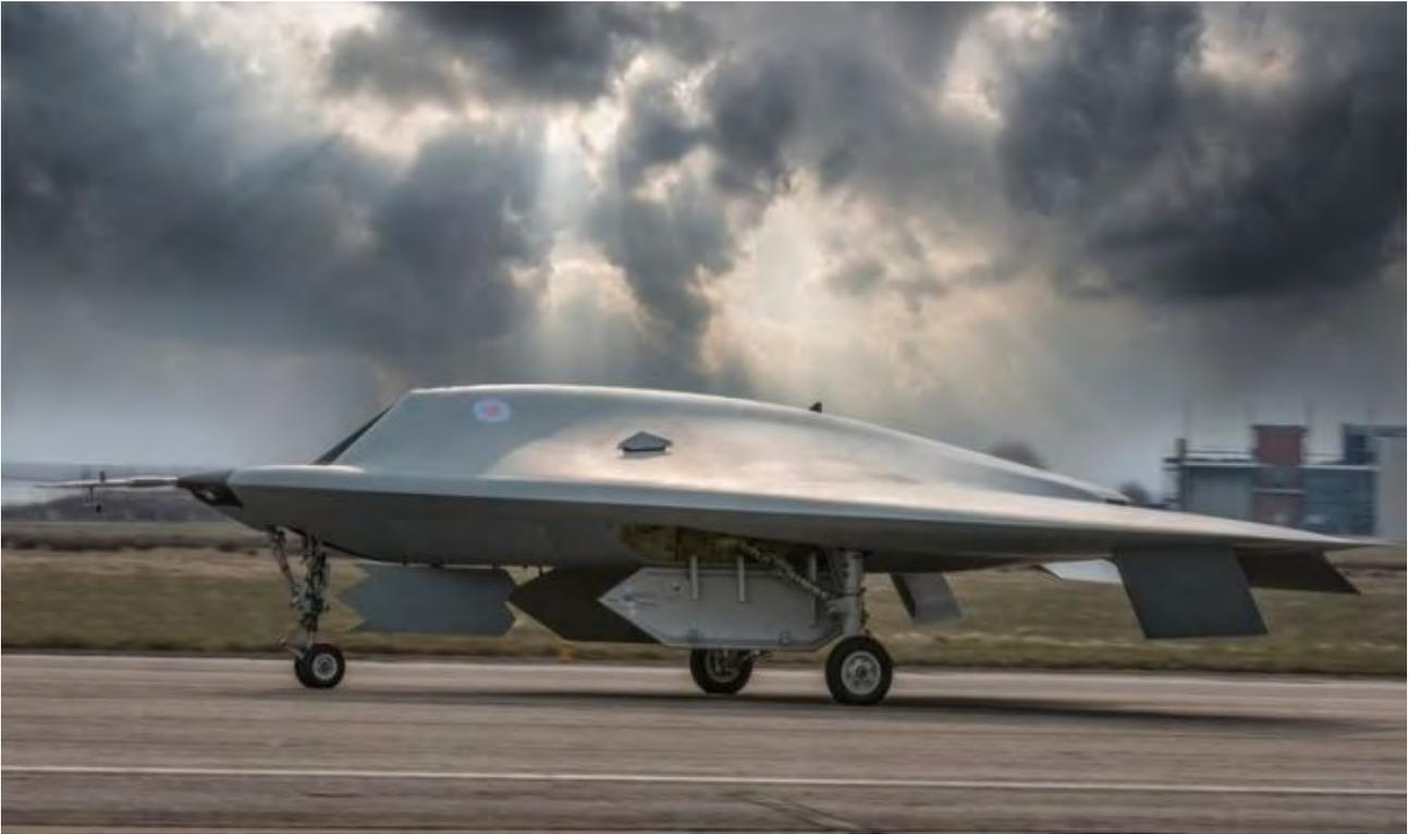
“雷神”验证机配备了惯性导航系统、全球定位系统、数字地图等组成的导航控制系统
