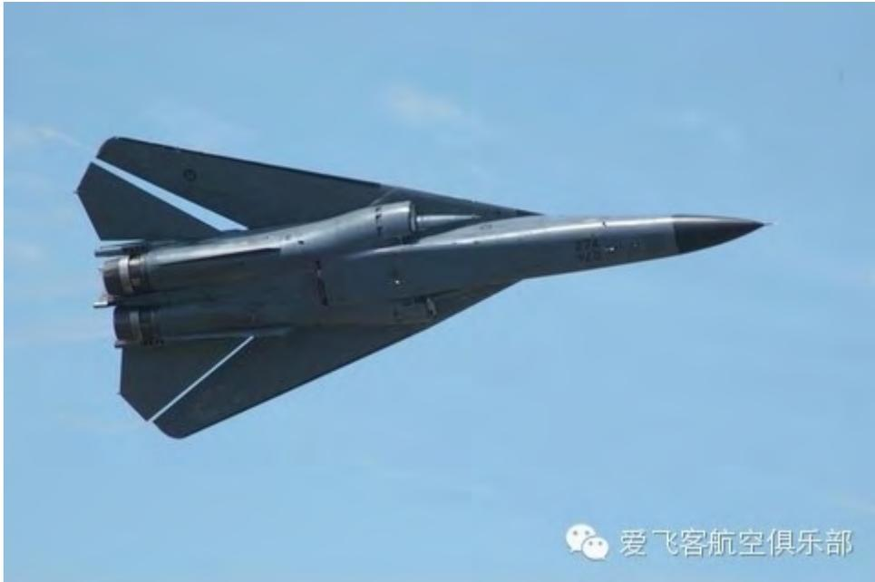
要改变机翼的后掠角，其实是很难的。机翼前后转动，要用很大的轴承和坚固的结构，这样，变后掠翼飞机的重量要增大。不过，随着气动力学的发展，人们发现边条机翼可以为其后方的基本机翼提供升力。所谓边条机翼就是在基本机翼根部前缘加装一条后掠角大于70度的边条。边条机翼既具有变后掠翼高低速兼优的性能，又具有重量轻、构造简单的特点。难怪今天许多新式飞机都采用了边条机翼。边条机翼的应用使许多重型战斗机的起飞、着陆性能大幅度提高。如苏-27的起飞滑跑距离仅400米，着陆滑跑距离也只有550米，对
