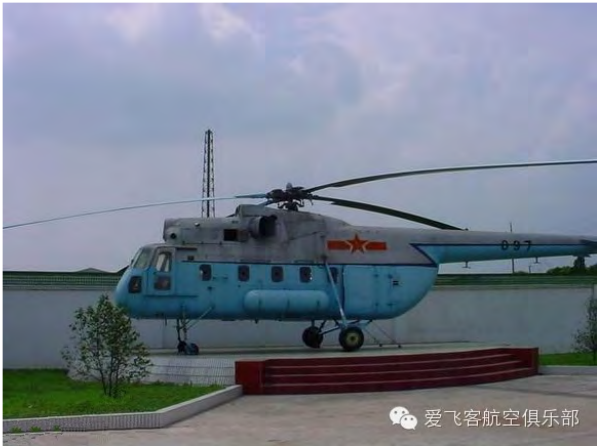
直-6 多用途直升机是哈尔滨飞机工业公司在直-5 基础上改型设计的以空降为主的多用途直升机，1969 年 12 月 15 日首飞。
