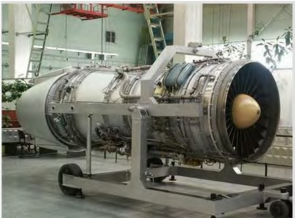
资料图：伊尔-76 采用的 D-30KP-2 涡扇发动机
