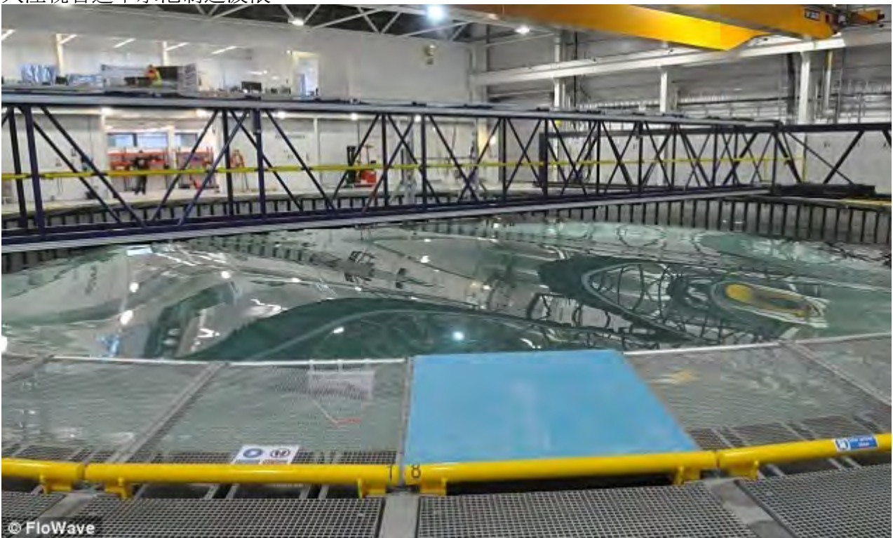
这个水池可用于制造快速水流和很高的波浪。它制造的水流能和奥运会游泳运动员一样快，
