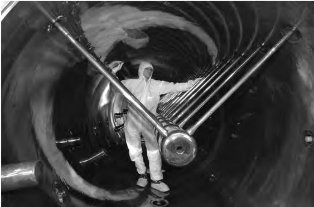
德国 GSI 亥姆霍兹重离子研究中心直线加速器能将钙离子加速至光速的 10%，以制造元素 117
