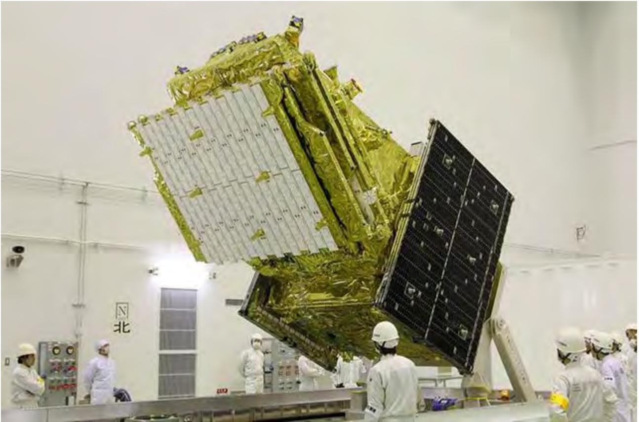
先进陆地观测卫星-2(ALOS-2)号卫星由日本[宇宙](#)研究开发机构、三菱重工联合打造
