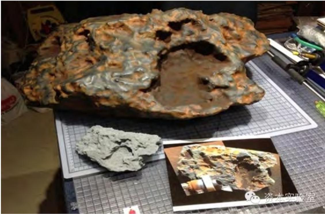
美国宇航局日前宣布，他们根据火星探测器传回的图片用 3D 打印机复制了一块火星上的陨石。该陨石是 2009 年发现的一块落在火星上的陨石。科学家们将其命名为布洛克岛 (BlockIsland)。布洛克岛是在火星上发现的最大的一块陨石，它有小冰柜大小，是一块铁镍陨石。布洛克岛的 3D 模型是根据 5 年前“机遇号”火星车上的 Pancam 全景相机拍摄的图像并经过精确的测量处理而成。但火星车看不到陨石每平方英寸的细节。这些丢失的数据在计算机模型形成了一个孔，这使得 3D 模型无法进行 3D 打印。去年夏天研究人员解决了填补丢失数据的难题，并建立了陨石的几个小模型。由于模型体积太大，研究人员将陨石的计算机模型分为 11 部分。然后，他们使用 FDM 3D 打印机将其打印出来。整个打印过程花了 305 小时 36 分钟。研究人员用 3D 打印机创建的陨石的 11 个部分，并把它们粘在一起形成真实尺寸的模型。
