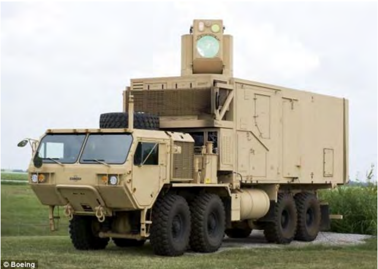
安装在卡车上的未来派激光武器，名为“高能激光移动验证器”。在2013年12月进行的测试中，高能激光移动验证器成功锁定并摧毁90多枚来袭的迫击炮弹以及6到7架无人机。 (吴锤结 推荐)
