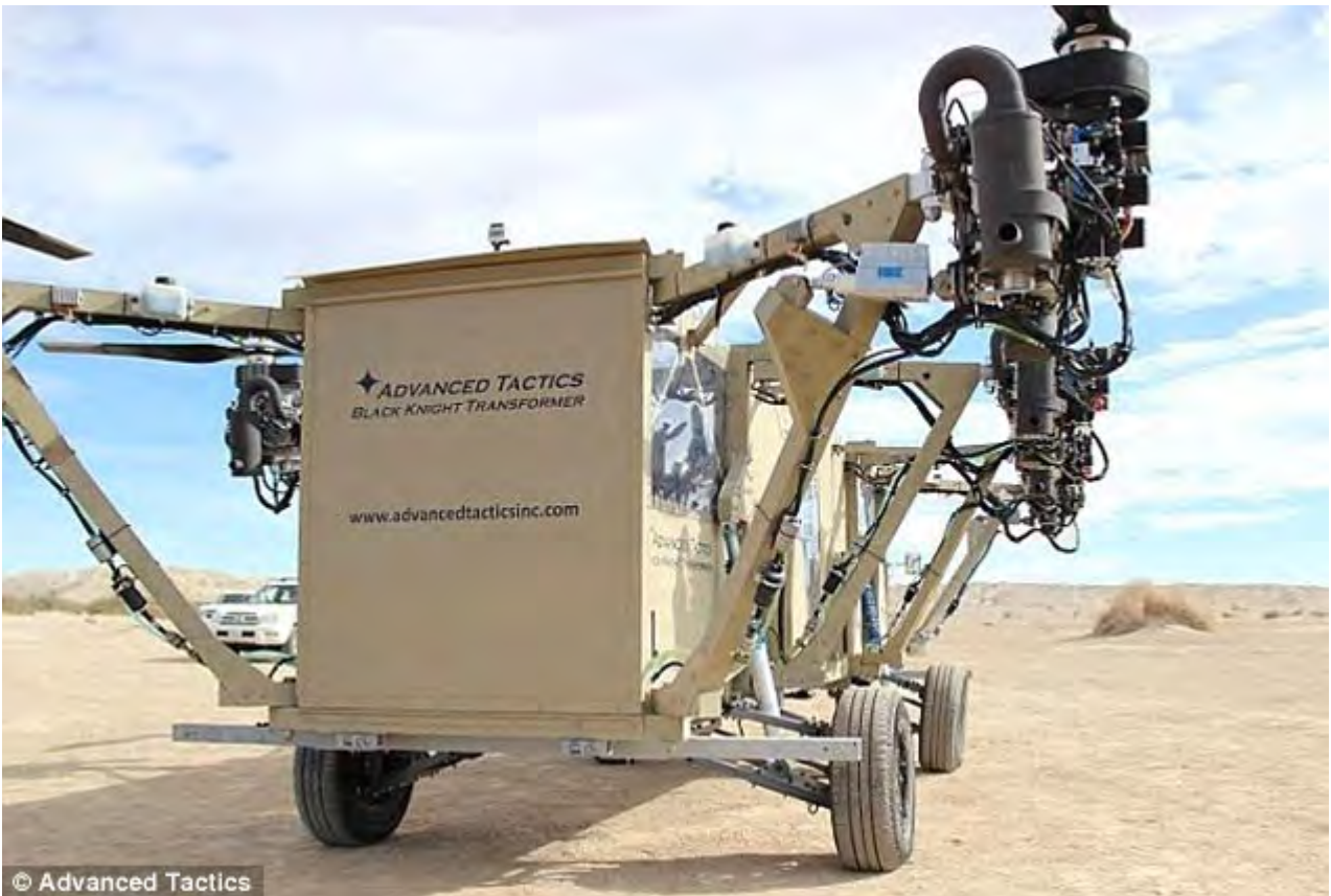
“高级战术”公司研制的无人飞行卡车“黑骑士变形金刚”，在地面上驾驶时与普通卡车差不多，同时可以像直升机一样起飞和降落。
