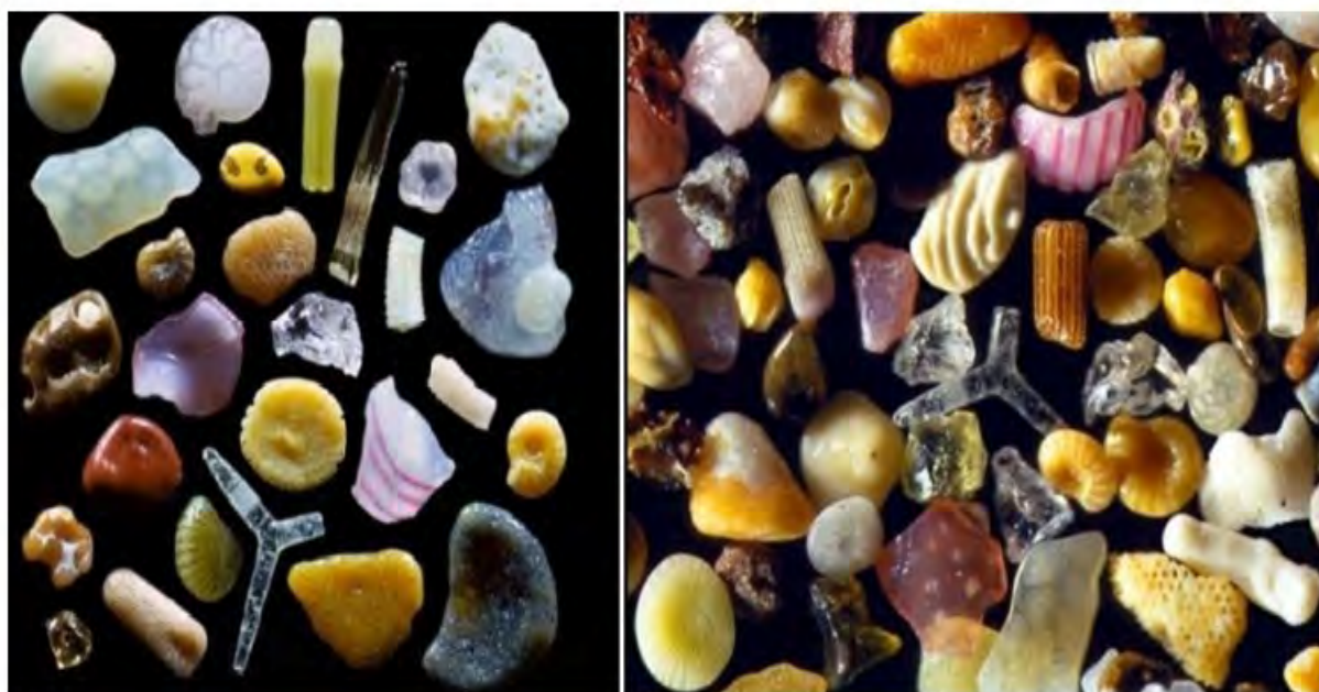
图 14 这是平常沙子在显微镜放大 300 倍后显示的各种晶体，它们虽然经过磨洗损伤，但还是能够看出规则的晶体形状
