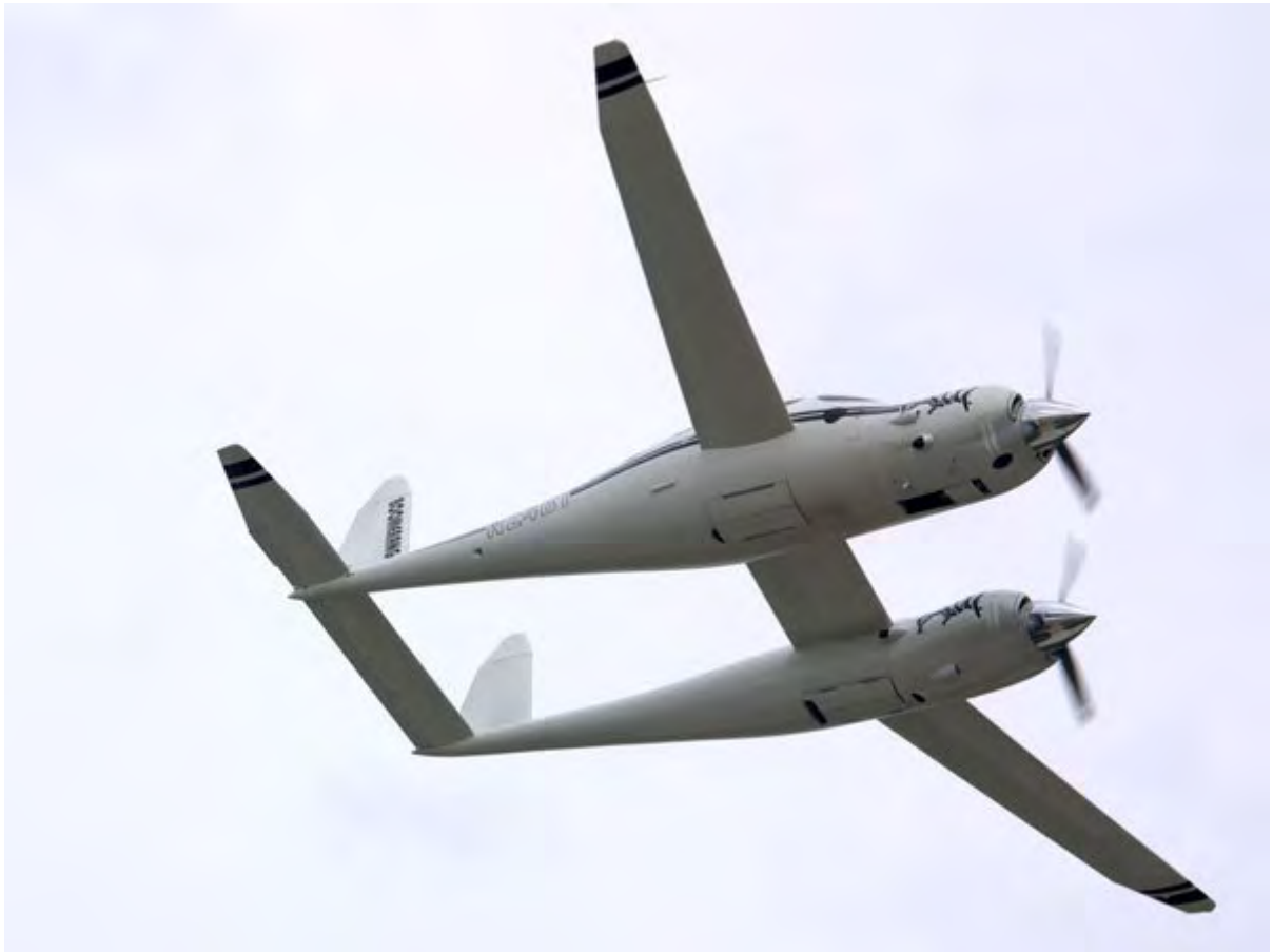
伯特-鲁坦设计的 202 Boomerang 原型机于 1996 年制造，采用双发动机设计。在其中一台发动机出现故障之后，飞行员仍能继续操控 202 Boomerang。
