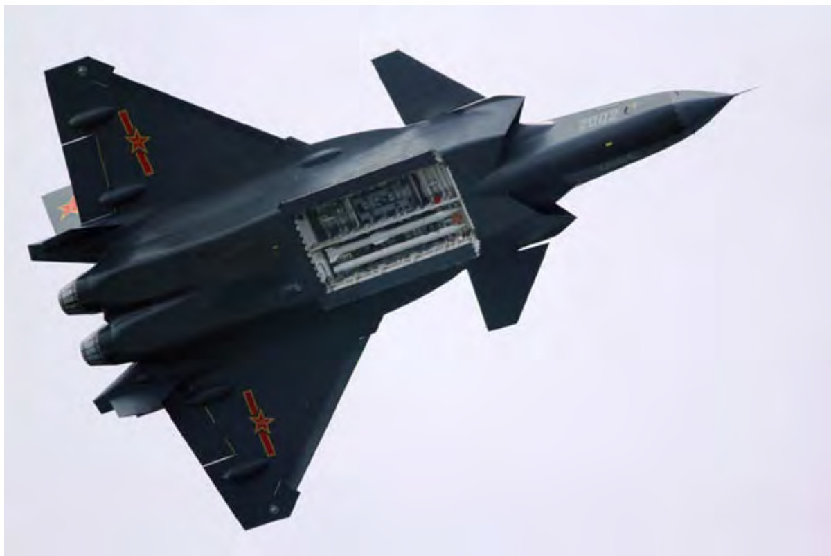
资料图：歼-20 四代机在试飞过程中打开机腹弹舱。
