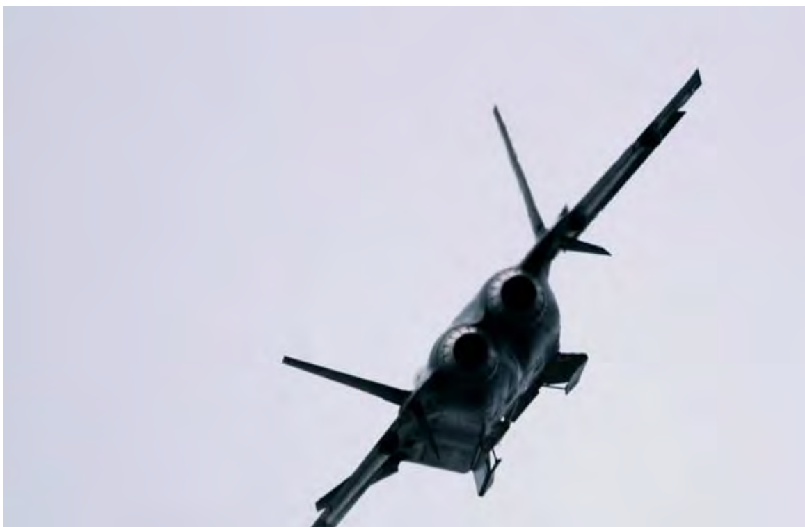
资料图：歼-20 四代机在试飞过程中打开机腹弹舱。
