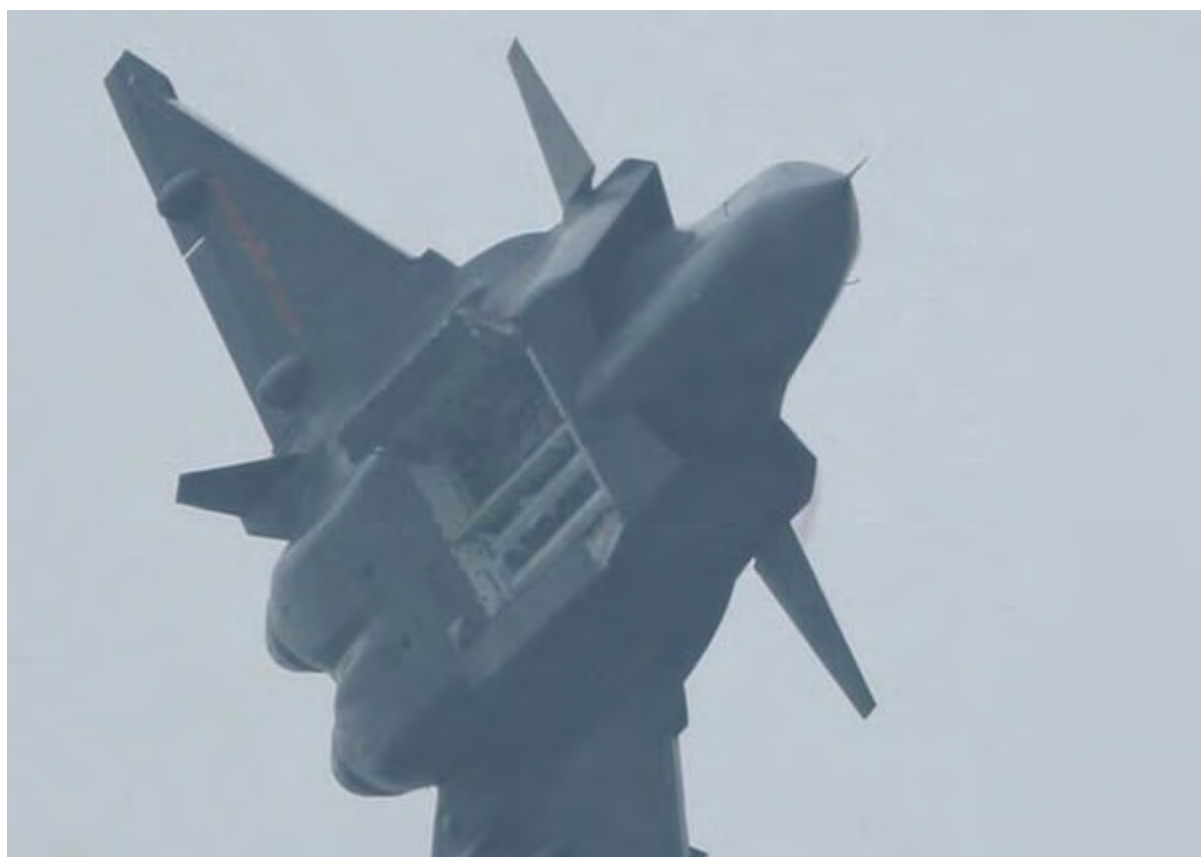
资料图：歼-20 四代机在试飞过程中打开机腹弹舱。
