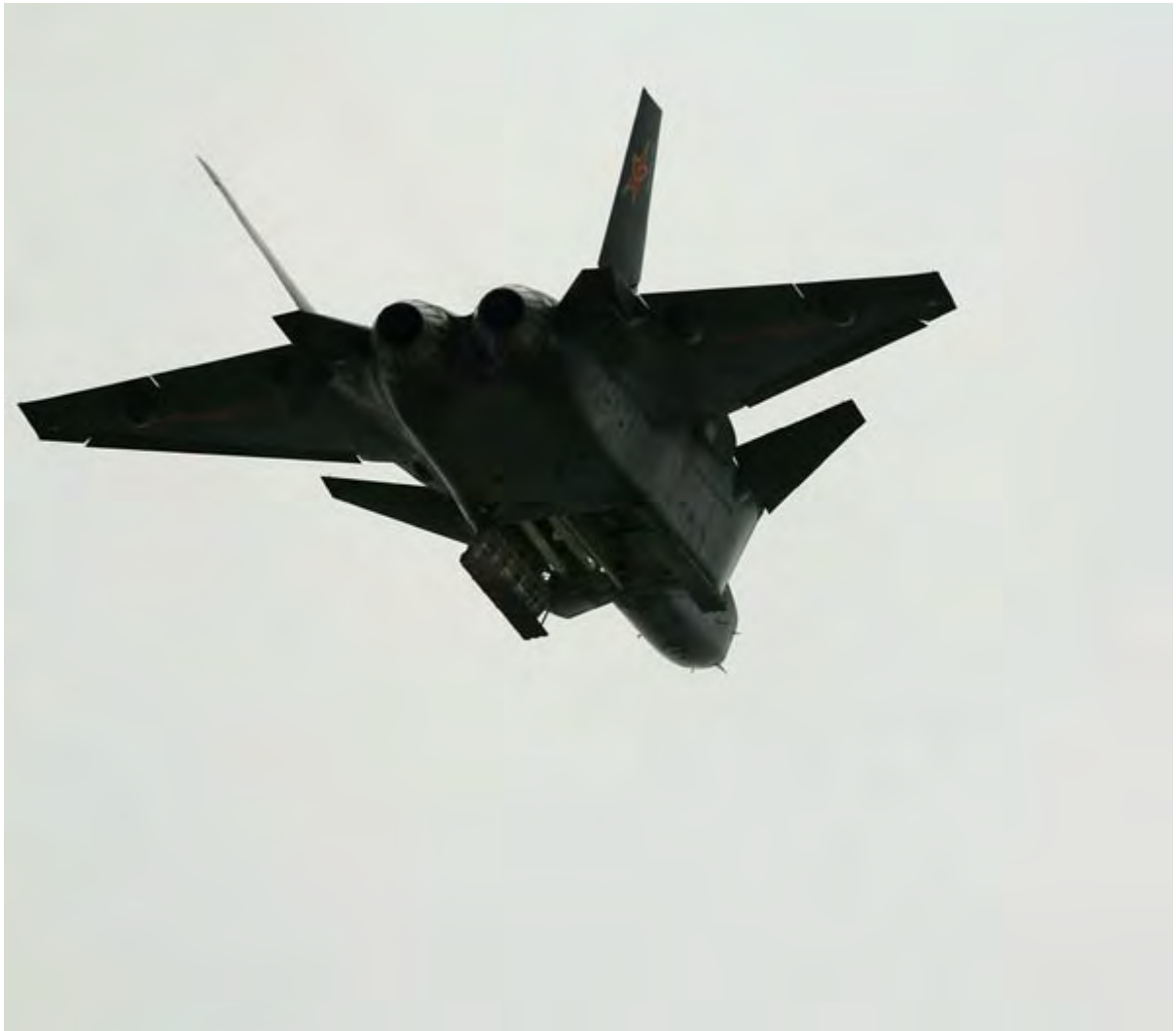
资料图：歼-20 四代机在试飞过程中打开机腹弹舱。
