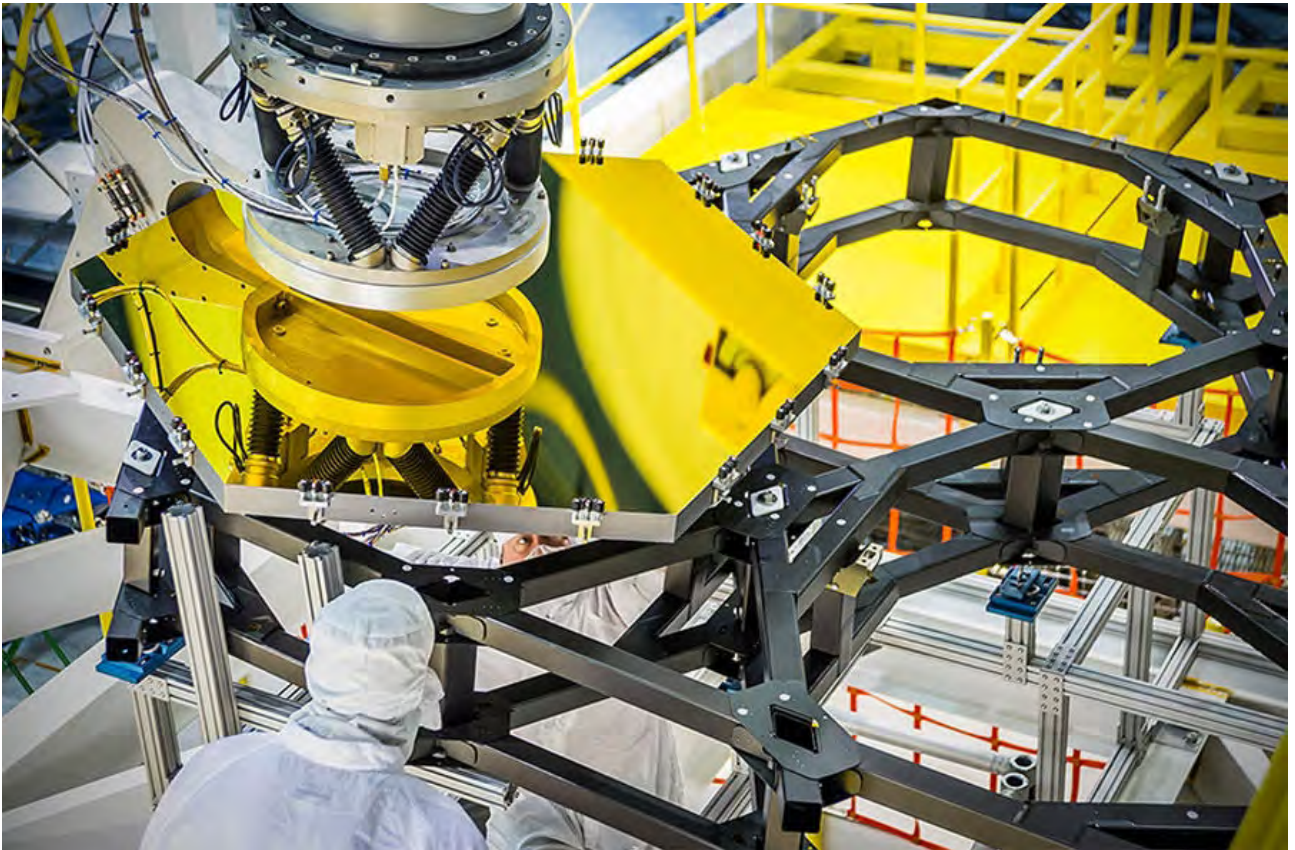
詹姆斯韦伯空间望远镜将接替哈勃，6.5米的主镜由六角镜面组合而成，其精度控制代表了最先进的制造工艺
