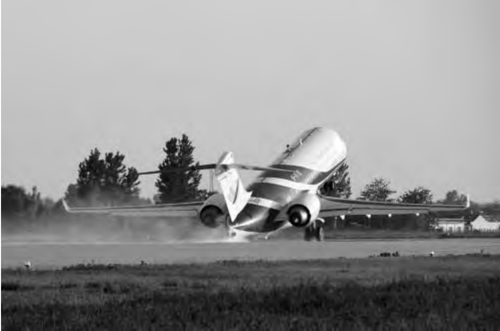
为确定飞机的最小离地速度，必须做机尾擦地起飞试验
