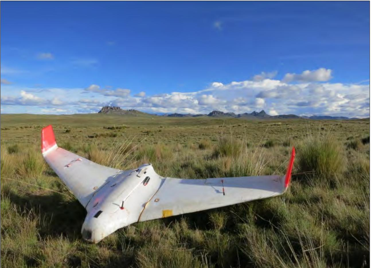
小巧的轻型无人机看起来就像是简单的飞机模型，但它们可以用于景观调查，拍摄数千张数码图片，用于合成三维地图。军事卫星及其他政府部门所用的卫星也能制作类似的地图，但不断更新的无人机系统技术使一些小公司和个人也掌握了这种能力。而且，随着技术发展，各种各样定制的功能也将被开发出来。
