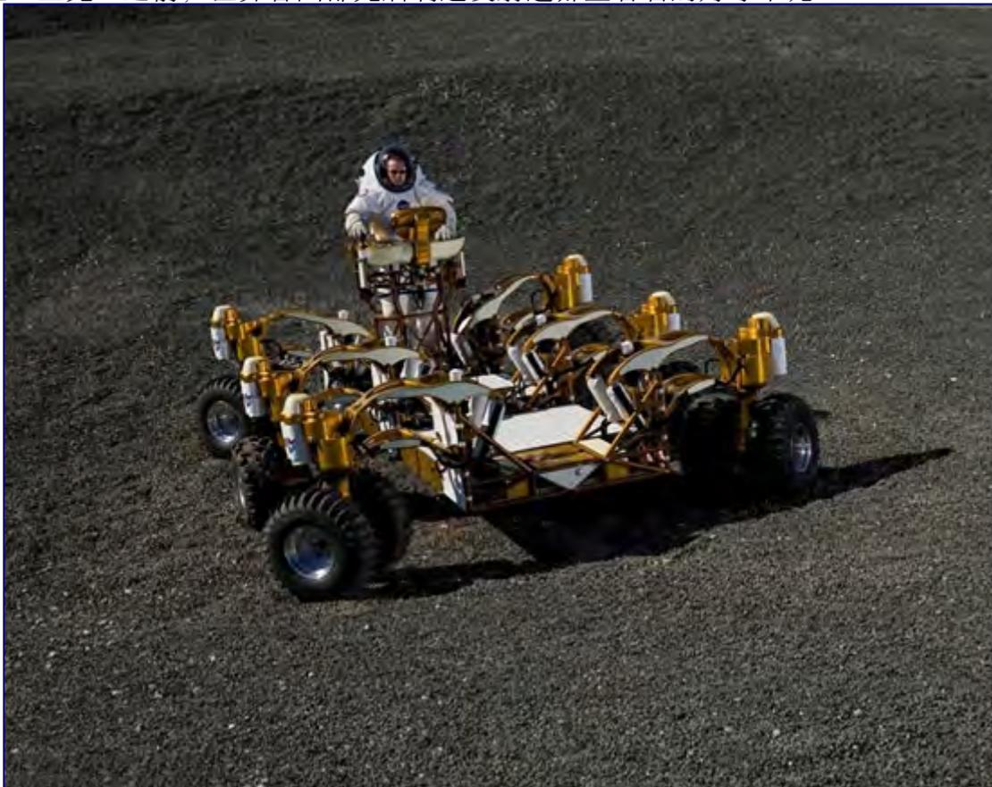
2008年，美国宇航局（NASA）推出的概念月球车可能有些离经叛道。它拥有主动（制导）悬架系统、6个可单独操纵的轮子、没有门、没有窗，也没有座位，唯一颜色是金色。但是，
