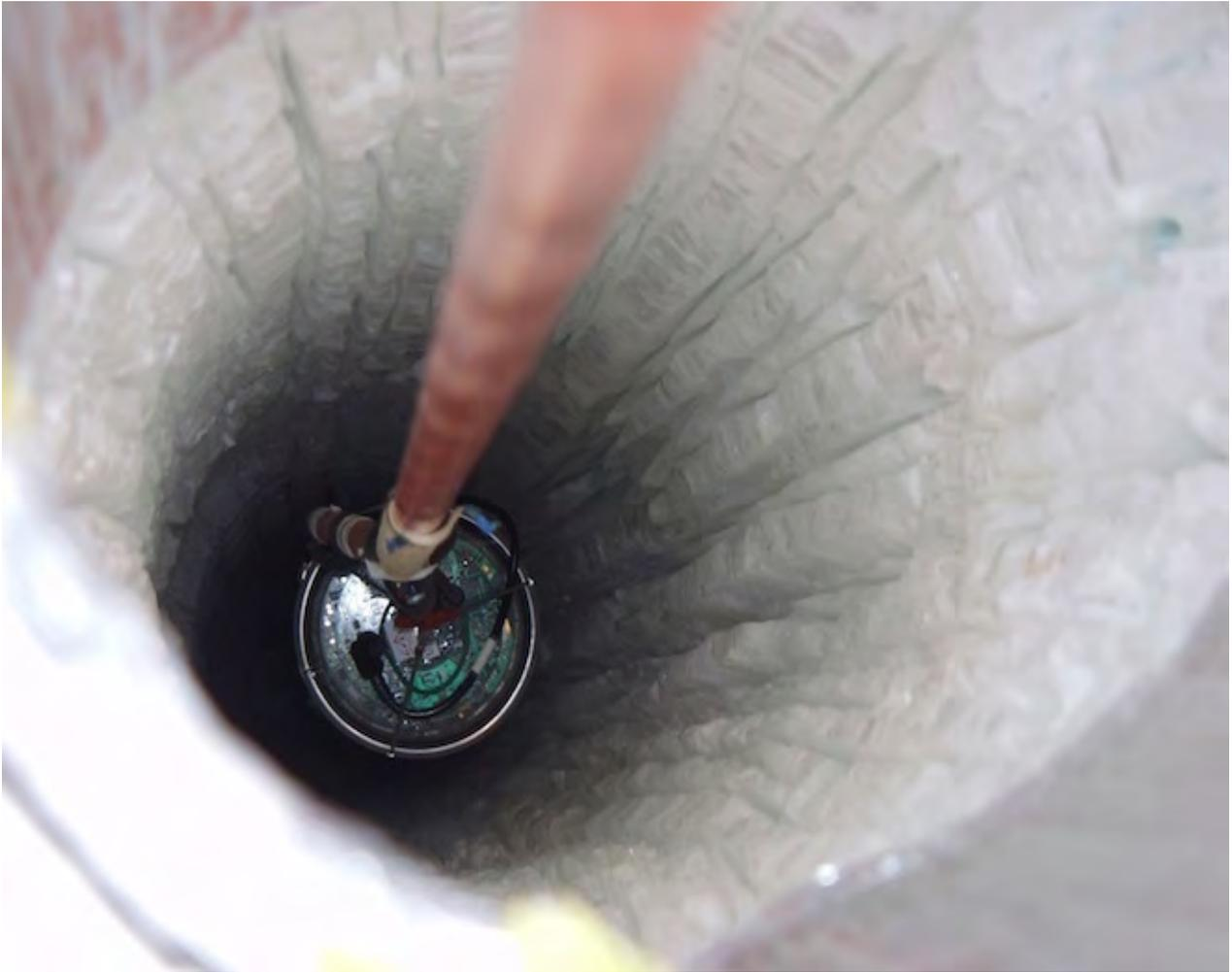
这是科学家们有史以来设计过的最疯狂的科学实验之一——将 1000 个探测器分布在 1 立方公里的南极冰雪之中，从而建成他们所谓的南极“冰立方中微子望远镜”，它将被用于监测来自太阳系以及银河系的中微子流
