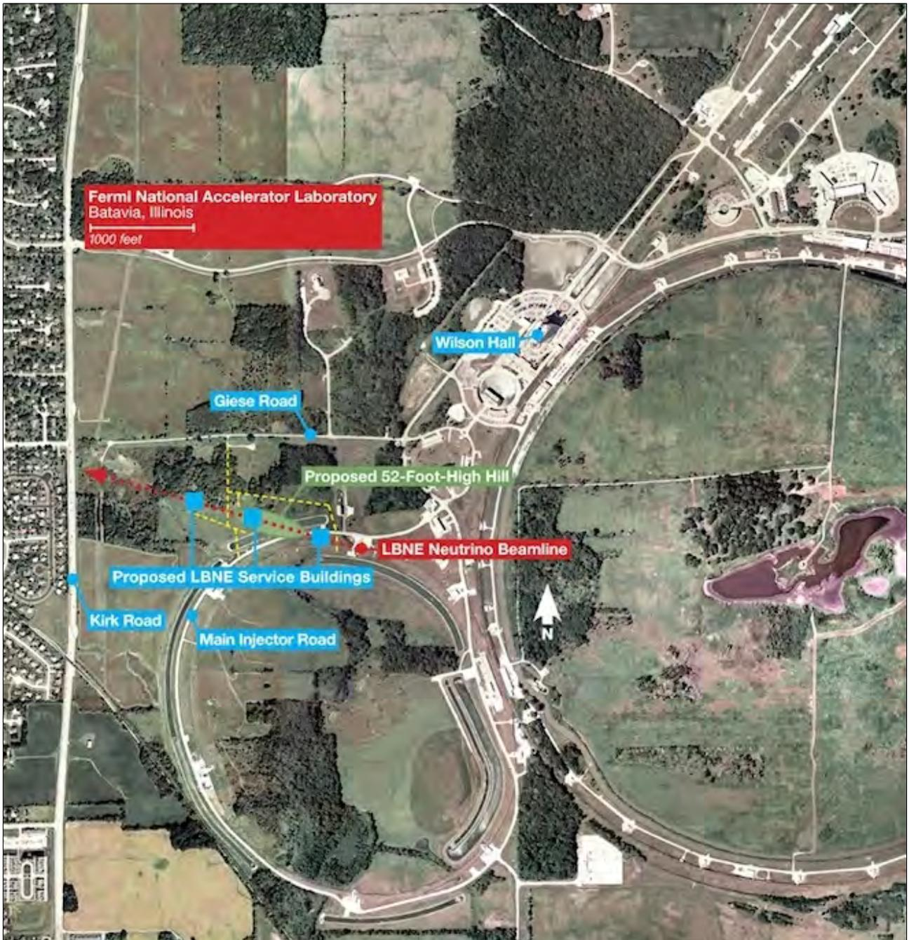
为了彻底弄清中微子的本质，美国物理学家们正试图推进一项大规模实验计划，名为“长基线中微子实验”（LBNE）。该装置位于南达科他州一处废弃的矿井内，将用于探测 130 公里外由费米国家实验室产生的中微子流
