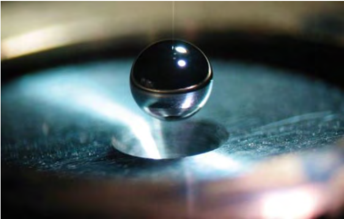
借助于 192 台世界上功率最大的激光器，美国国家点火设施的科学家对一个小氢球进行加热，加热到数百万摄氏度。在随后的几纳米时间里，小氢球发生爆炸，所释放的能量超过引发核聚变消耗的燃料
