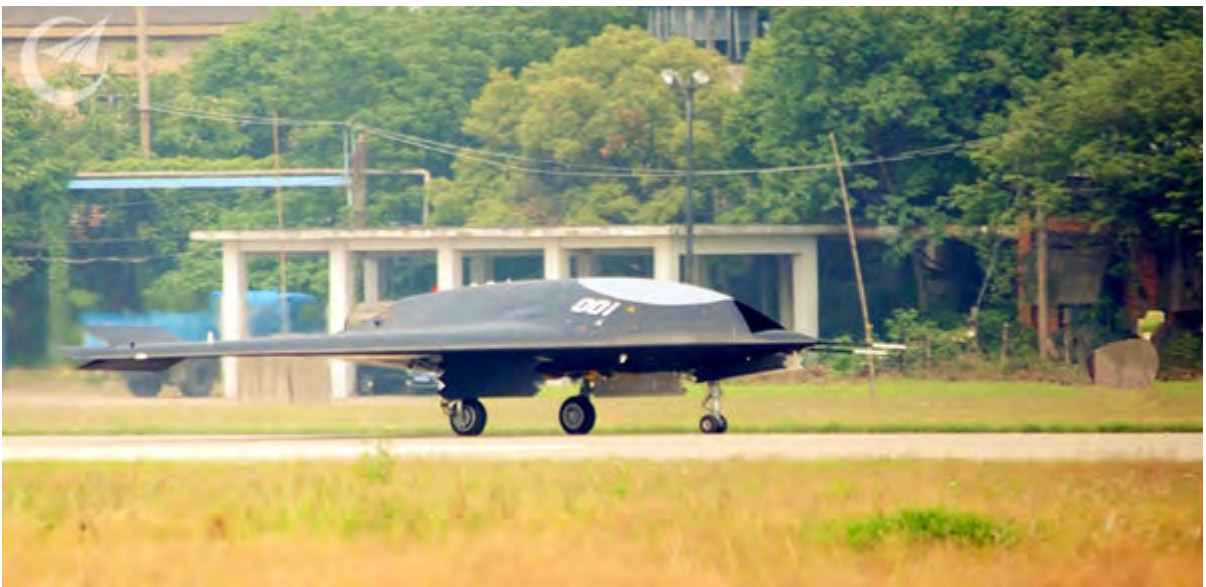
资料图：利剑的无人机进气道明显后掠，这明显是为了提高进气口的隐身能力。
