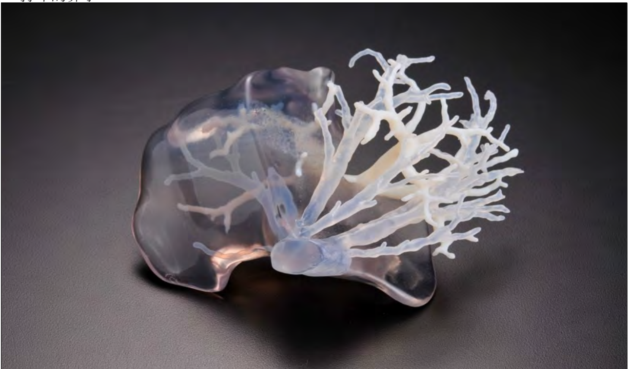
以光聚合树脂为原料，3D 打印出来的透明肝脏模型。安东尼·阿塔拉 (Anthony Atala) 对 3D 打印器官的研究最终将宣告器官捐献和动物实验的结束。
