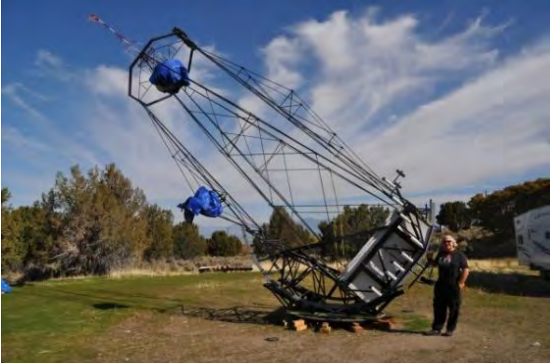
这架望远镜高度约为 10.7 米，镜面直径约为 1.8 米。这或许是当今世界上最大的由业余天文爱好者制作的望远镜
