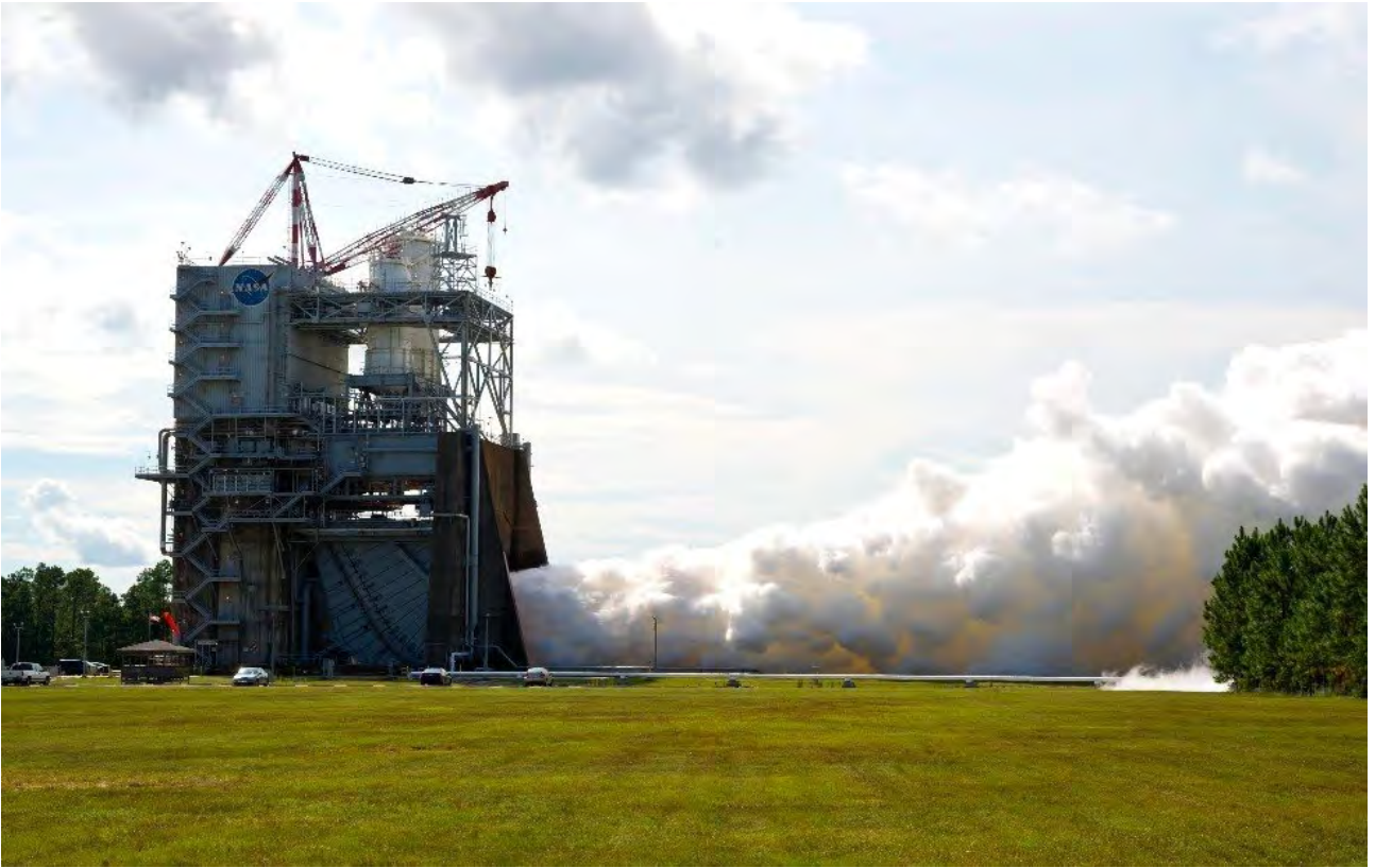
7. 斯坦尼斯航天中心 A-1 试验台对 J - 2X 发动机进行测试的图片，点火时间为 330 秒。
