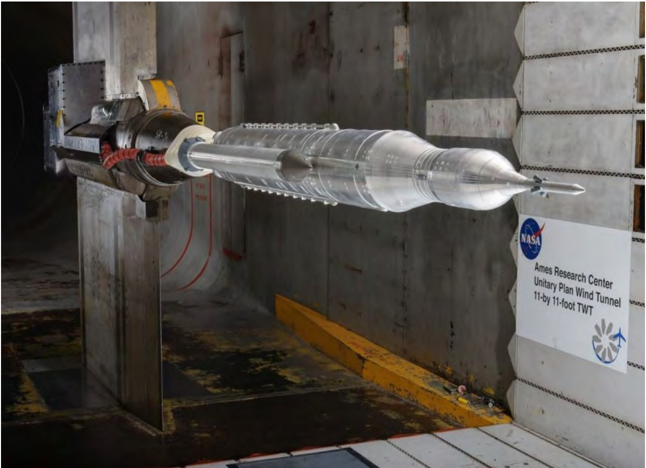
1. 艾姆斯研究中心 11×11 英尺跨声速风洞内进行测试的 SLS 火箭
