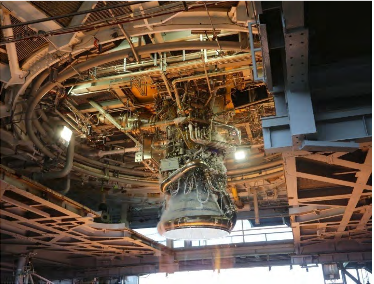
8. J-2X 火箭发动机特写镜头，该发动机为氢氧机，强大的上面级是 SLS 火箭拥有恐怖运载能力的保证。
