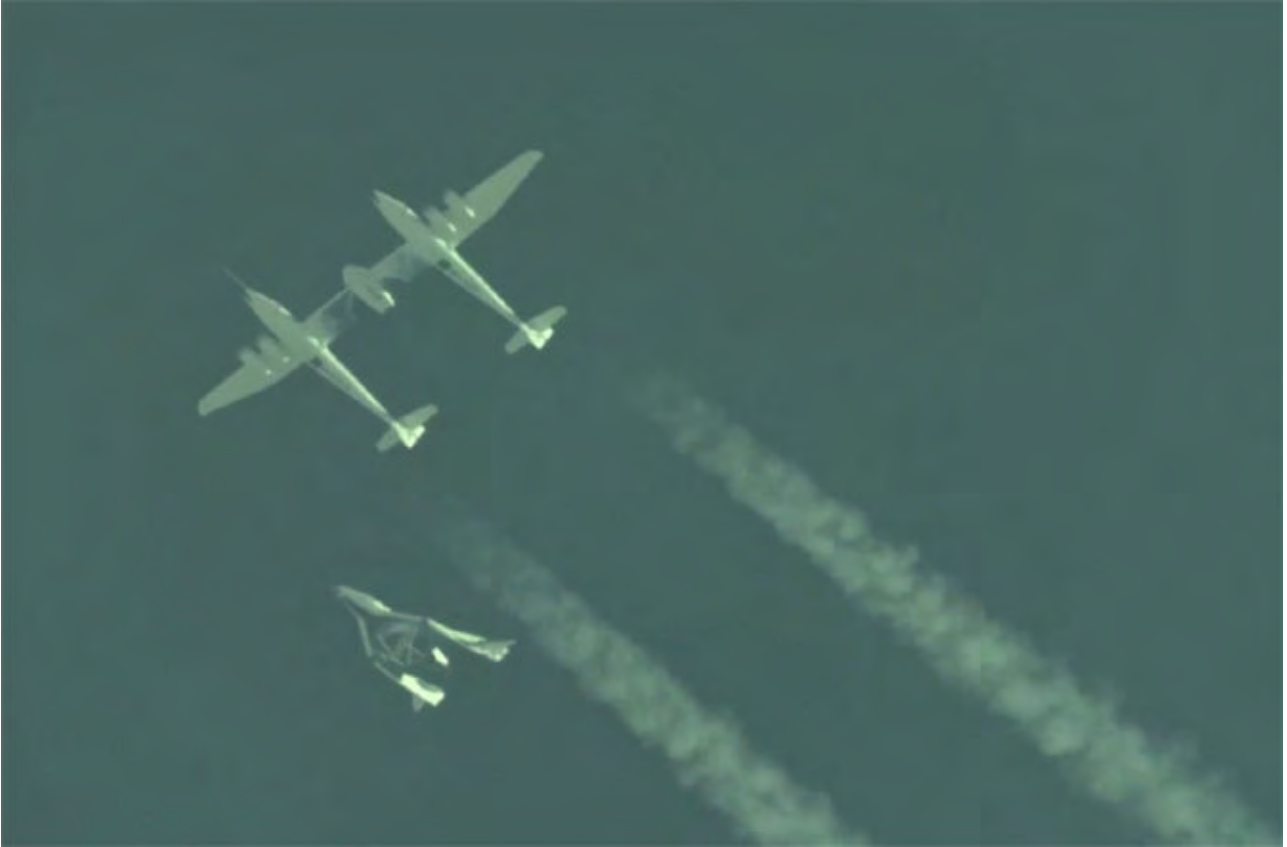
7.处于试飞状态的“太空船2号”亚轨道飞船，其由白骑士系列载机投放，然后启动火箭发动机
