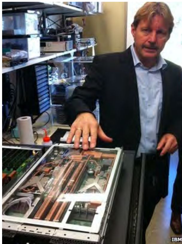
IBM 公司的计算机模型使用液体传递能量和转移热量
