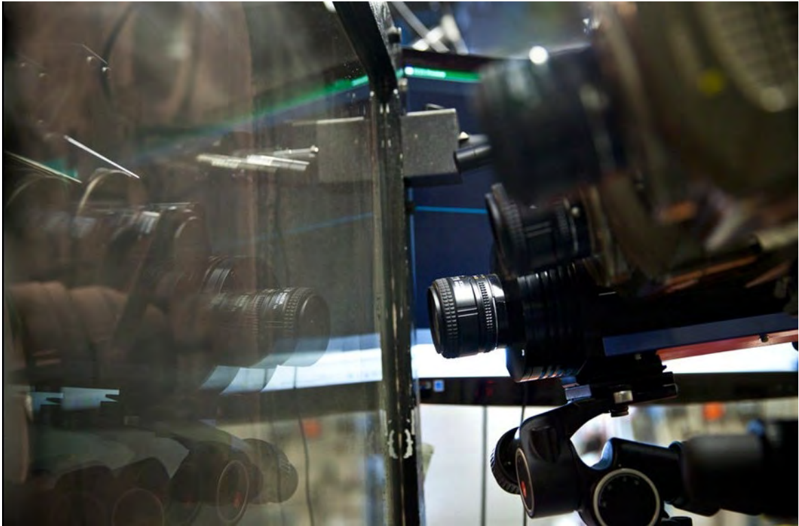
高速摄像机以百万帧每秒的速度记录模拟撞击的细节
