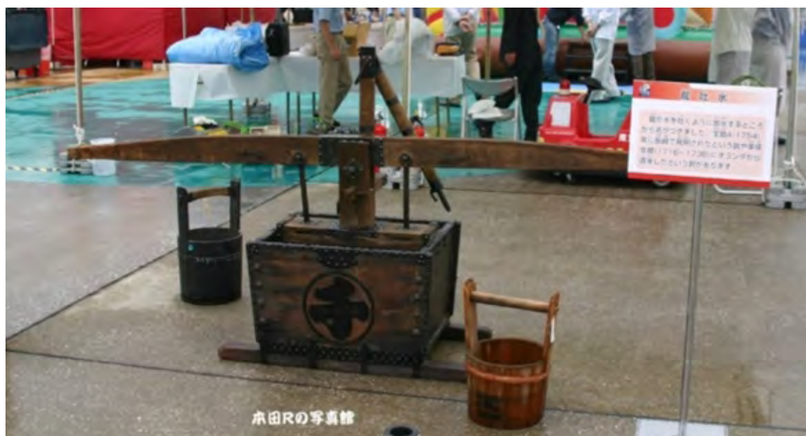
图11.日本1754年间的“龙吐水”，是指荷兰技师的指导下设计制造的，也是类似于中国土龙型泵浦的设计。
