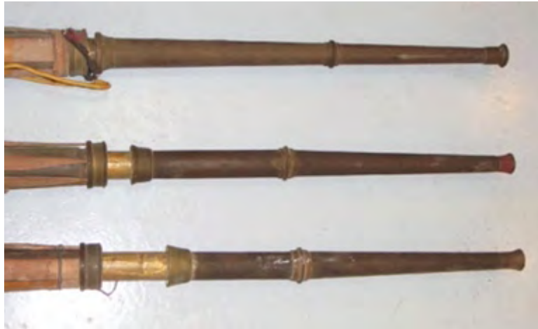
图 1. 水枪：清代的消防水枪（注意，可以伸缩，用来挤压内部的水流）大约是 1430 年最早出现在欧洲。
