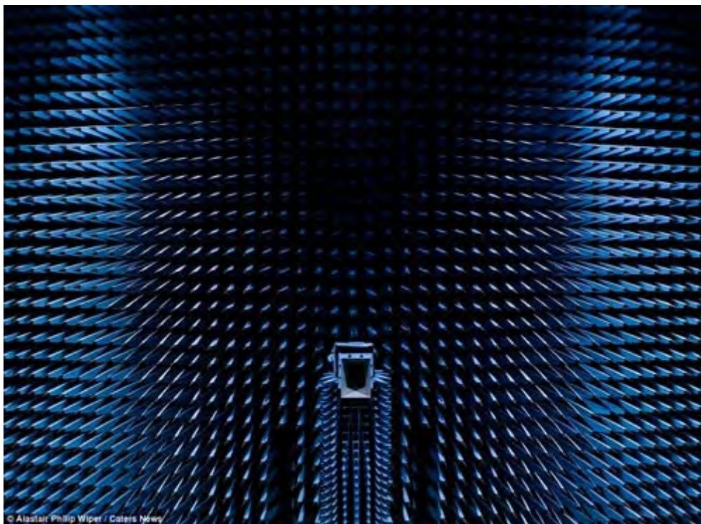
最新摄影展呈现世界上重要的科研机构，图中是丹麦科技大学的消音室
