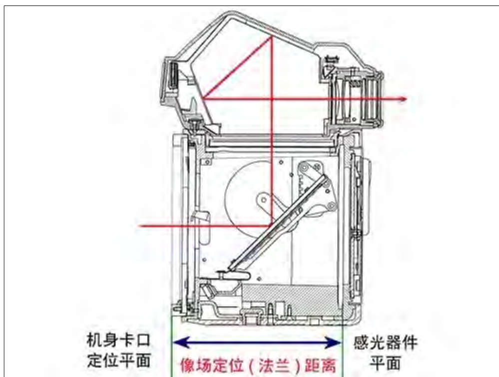
法兰距的定义如上图所示 图片来源: 新摄影
