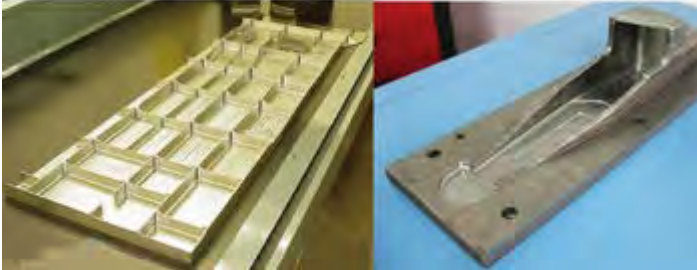
图3 美国 AeroMet 公司的激光快速成形系统及其制备的钛合金飞机机身隔框等
