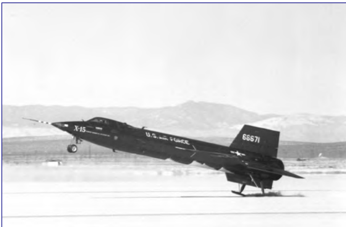
3. X-15 验证机可通过滑橇降落装置安全返回地面，美国空军曾希望其能成为一名载人太空飞行器
