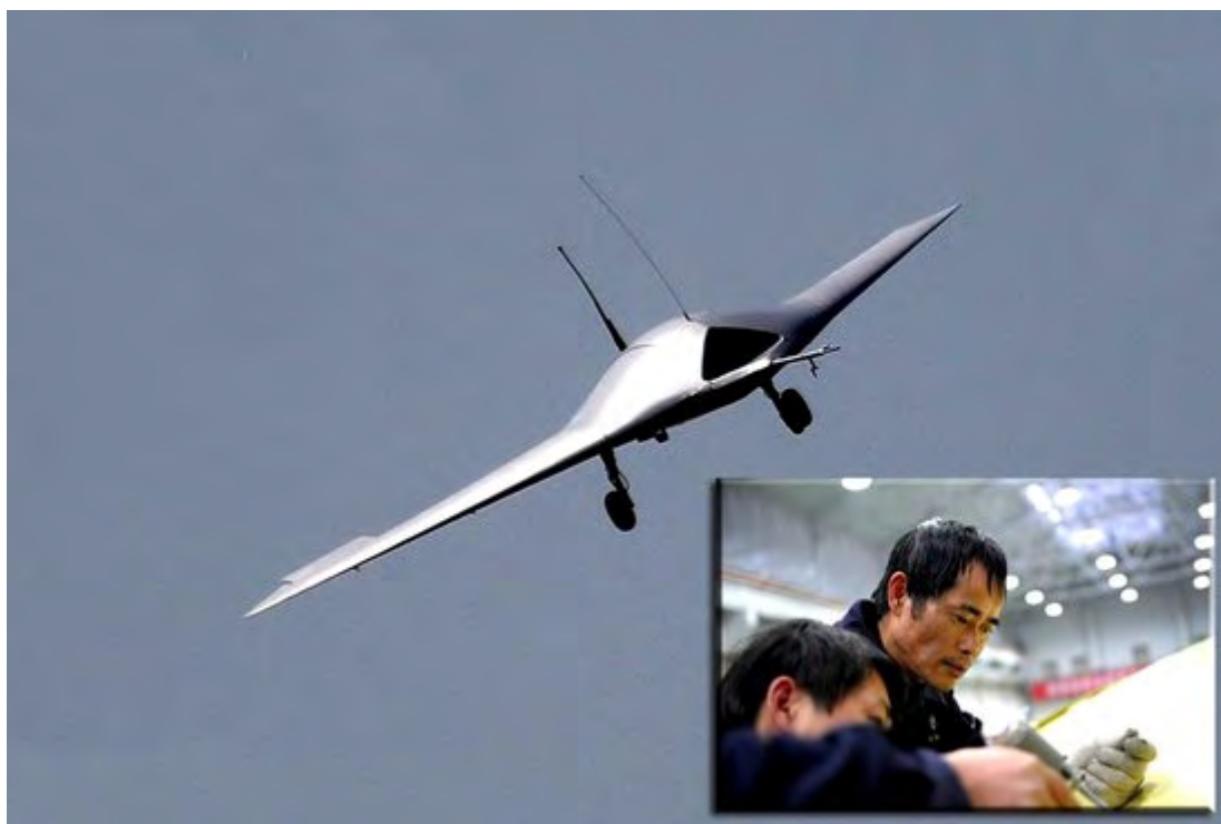
利剑无人机小尺寸模型空中试飞，以及原型机装配照片。
