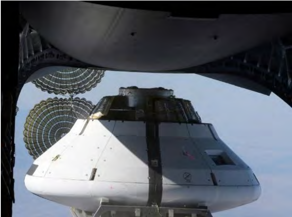
NASA 的猎户座飞船进行降落伞系统测试，图中两个风向指示筒可将飞船拖出 C-17 的货舱
