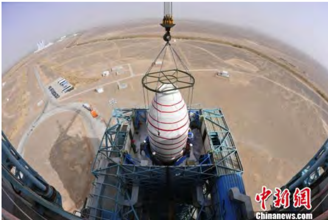
图为发射前夕，“高分一号”卫星与运载火箭在发射塔架进行对接。梁杰 摄
