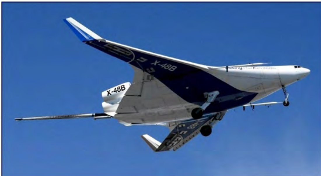
X-48B 尾部配备了三台发动机，而 X-48C 只有两台
