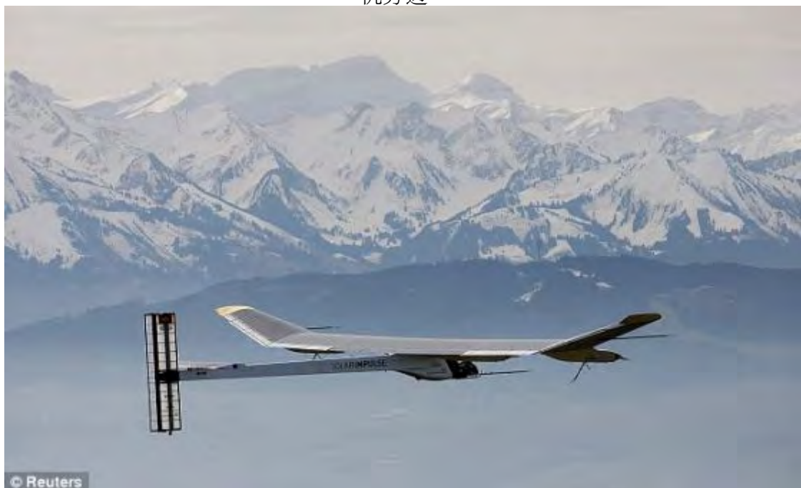
阳光动力 HB-SIA 飞机由 4 个电动机提供动力，旨在用从高效蓄电池的太阳能电池节省下来的剩余能源进行日夜飞行。
