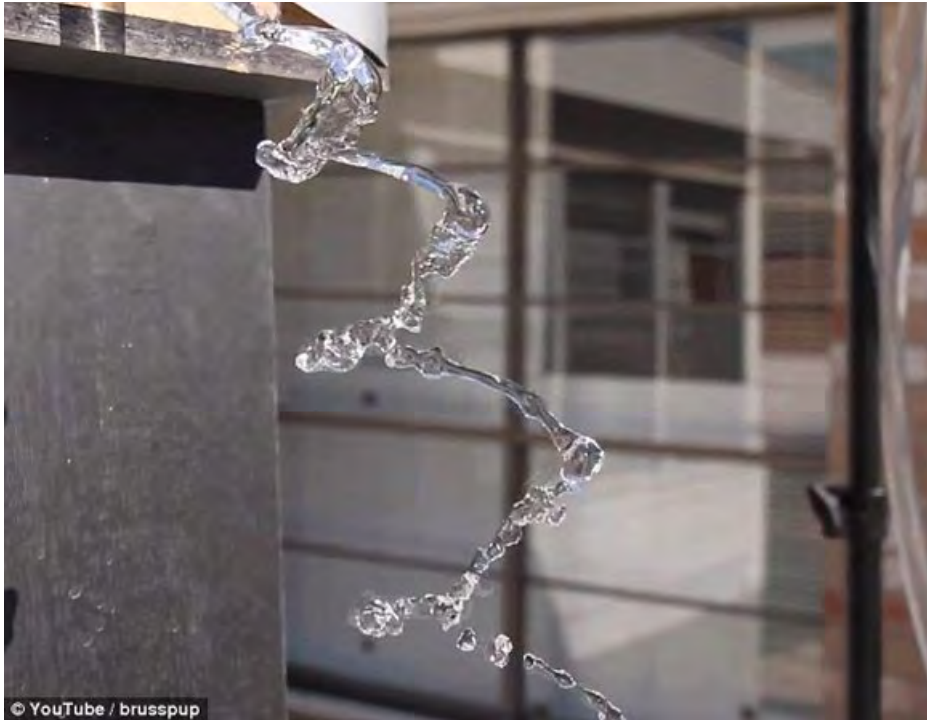
在 24 赫兹的超低音频震动下，垂直的水流变成了螺旋状
