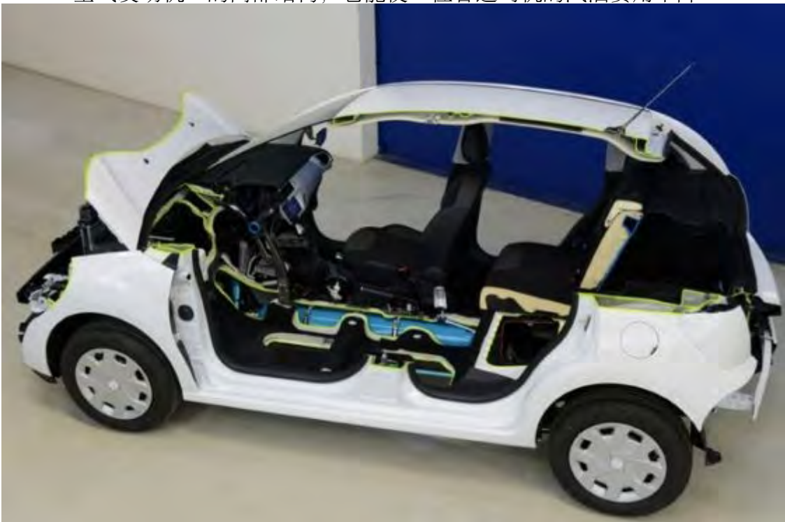
标致雪铁龙集团已经公开展示用压缩空气取代电流，充当汽油的配角的空气动力车
