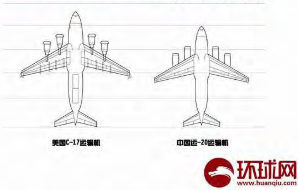
中国运-20运输机与美国C-17运输机尺寸比较示意图 (来源网络图片绘制 仅供参考)
