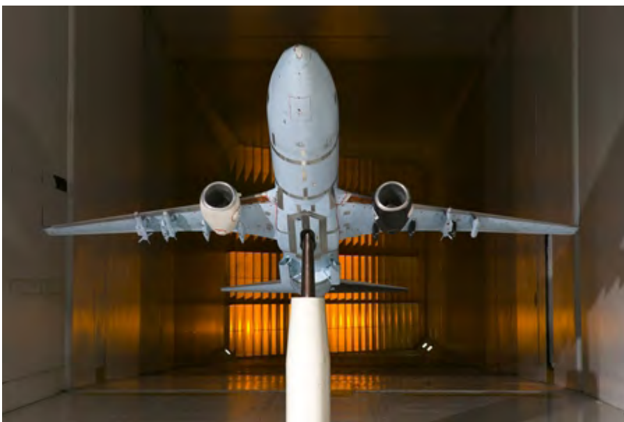
资料图：飞机模型进行风洞试验。
