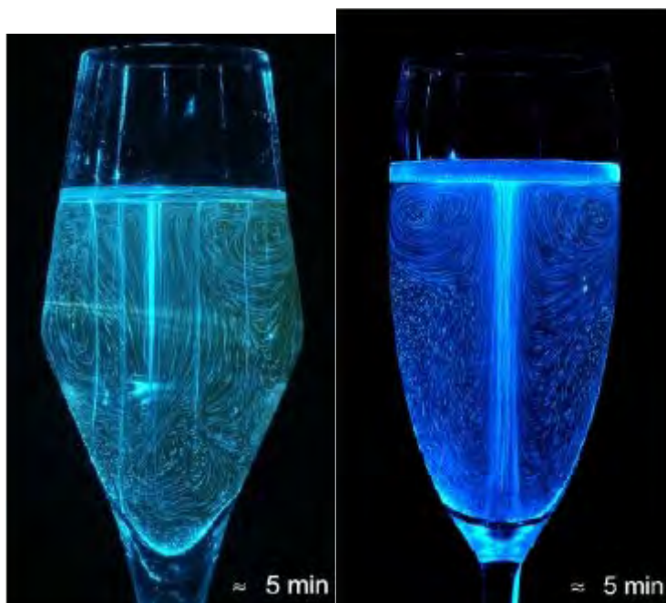
图六 向经过和未经过蚀刻处理的酒杯中倾倒香槟酒后产生的内部流场的对比。左侧：未经过蚀刻处理的酒杯；右侧：经过蚀刻处理的酒杯。
