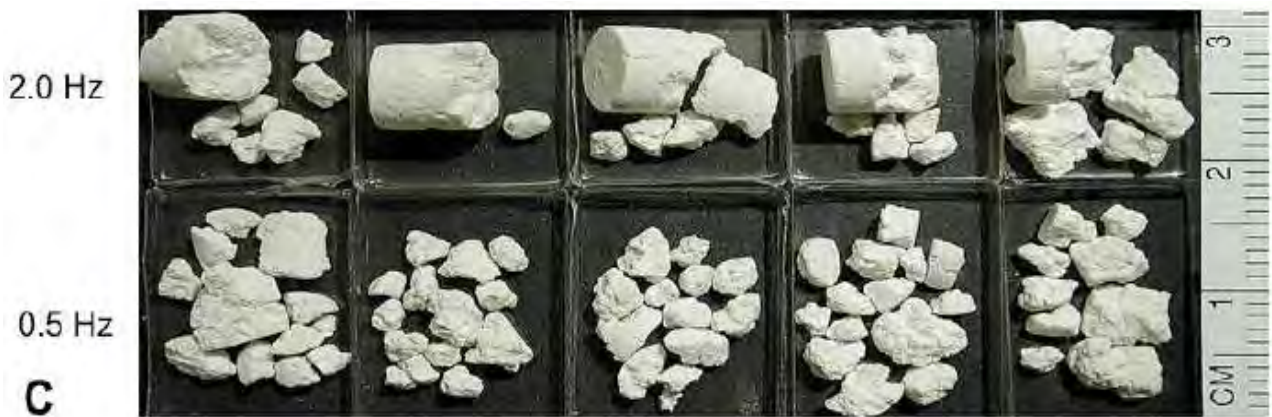
不同激波传送频率对结石粉碎的影响。图片来自 Crum et al. (2008, Fig.2c).
