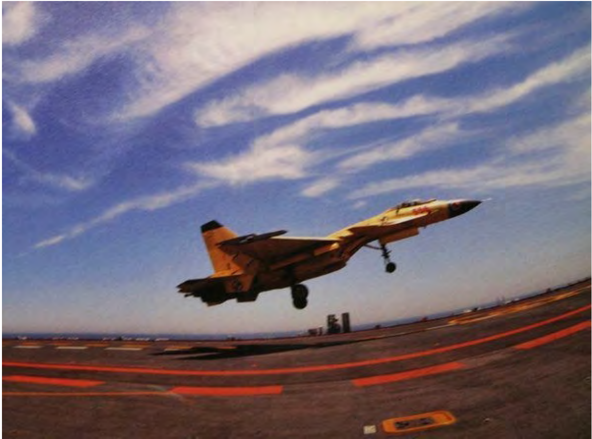
资料图：歼-15 舰载机触舰复飞瞬间，着舰尾钩并没有放下。
