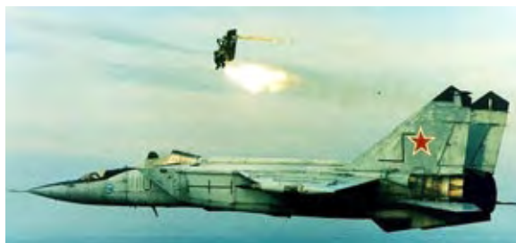
由米格 25 双座战机改装而成的弹射试验机
