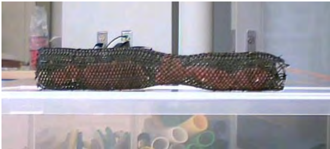
机器蠕虫外部通过特殊记忆合金材料制作而成
