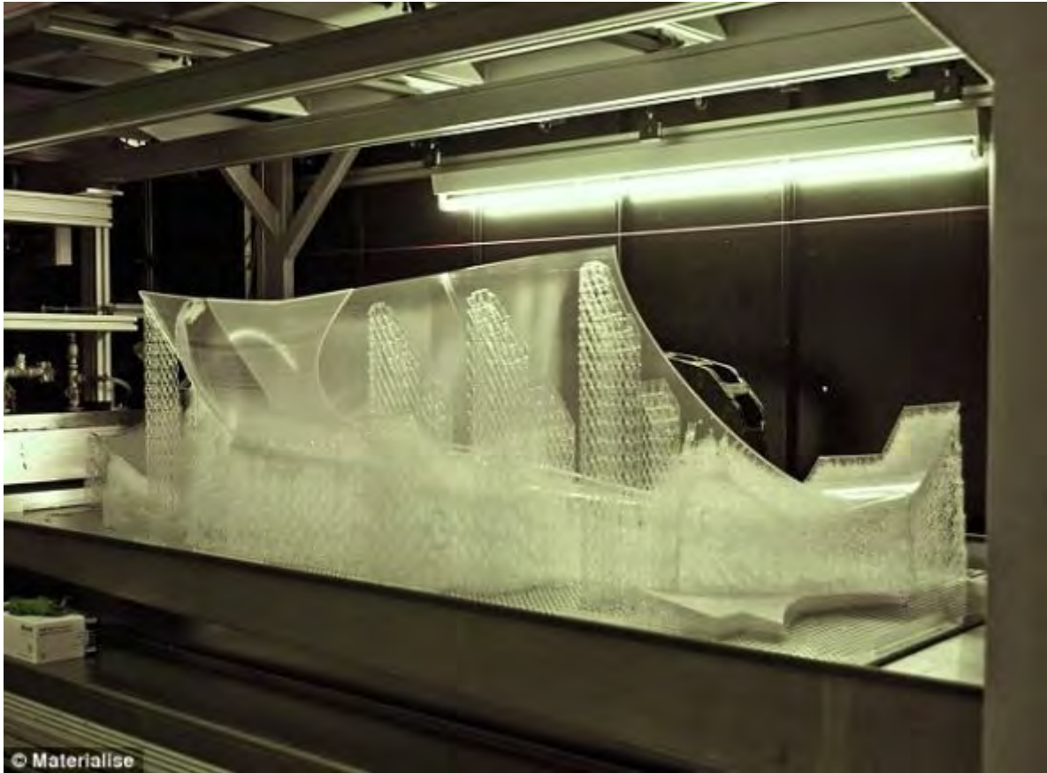
Materialise 的 3D 打印机，能够逐层打印任何塑料物体
