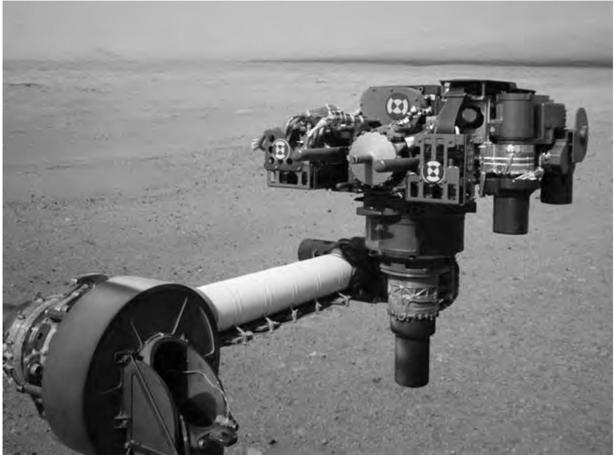
8月20日，美国宇航局“好奇”号火星车拍摄了长达2米的自身机械臂，此时距它顺利登陆火星已有两周。跟一辆小轿车差不多大的“好奇”号火星车这几天对自身运行状况进行了多项检查，确保它的五个主要部件都能正常工作。机械臂顶端有一个60厘米宽、32千克重的转台，转台上的工具会对火星表面采集的岩石样本进行分析。
