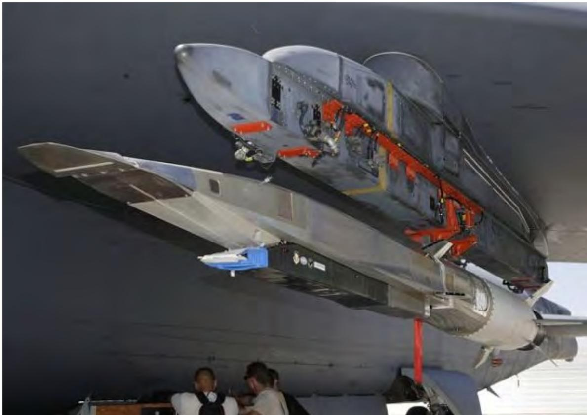
测试时，这架试验机绑在一架 B-52 轰炸机的机翼下方。释放之后，X-51A 的超音速冲压喷气
