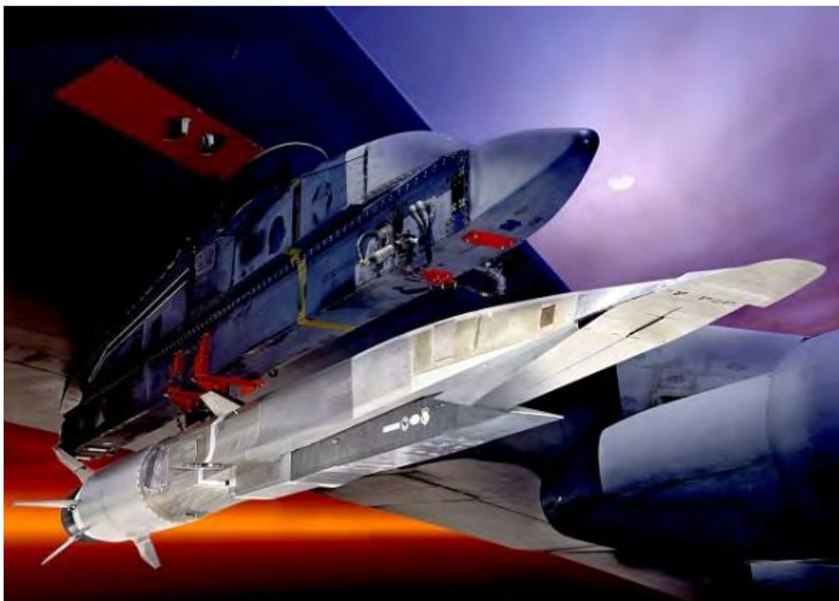
超音速冲压发动机在设计上利用自身产生的冲击波，能够将 X-51A 的速度提升到 6 马赫左右
