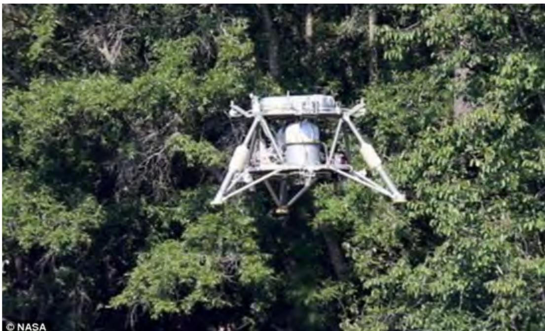
“巨鹰”飞行器盘旋在空中，这种原型登陆器正在接受一系列最新测试，准备部署于太空探索任务
