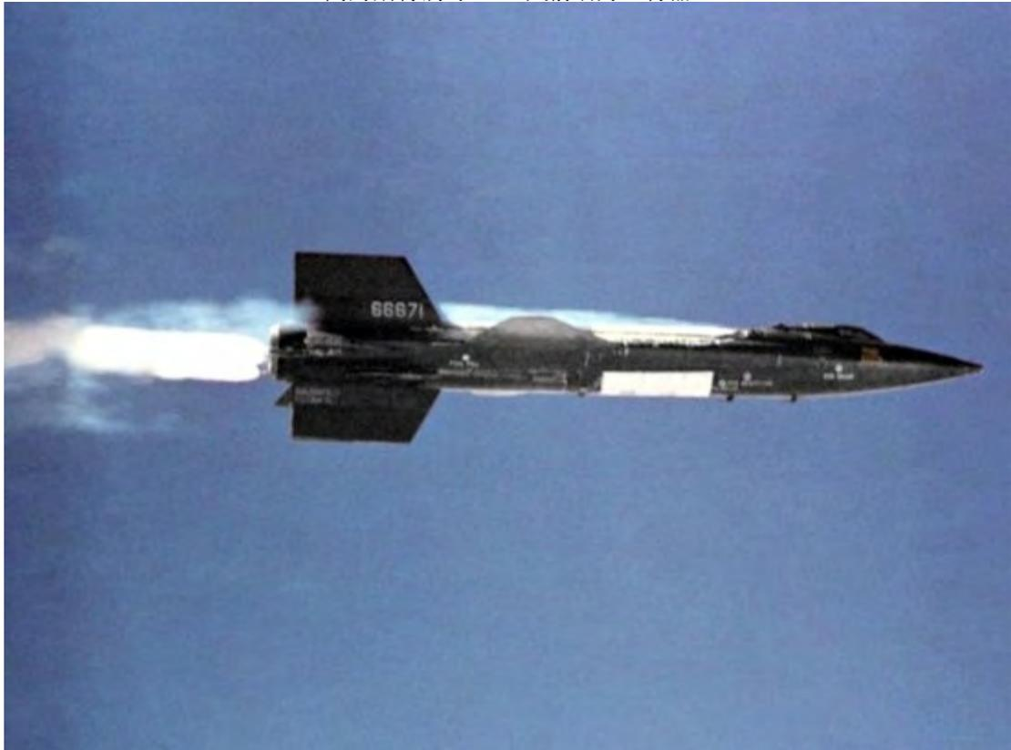
X-15 火箭动力飞行器由北美航空研制试验机
