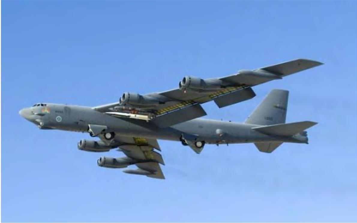
X-51A “乘波者”依附在 B-52 “同温层堡垒”轰炸机机翼下方。此前进行的一次测试创造了超音速冲压发动机极超音速飞行的最长飞行时间纪录
