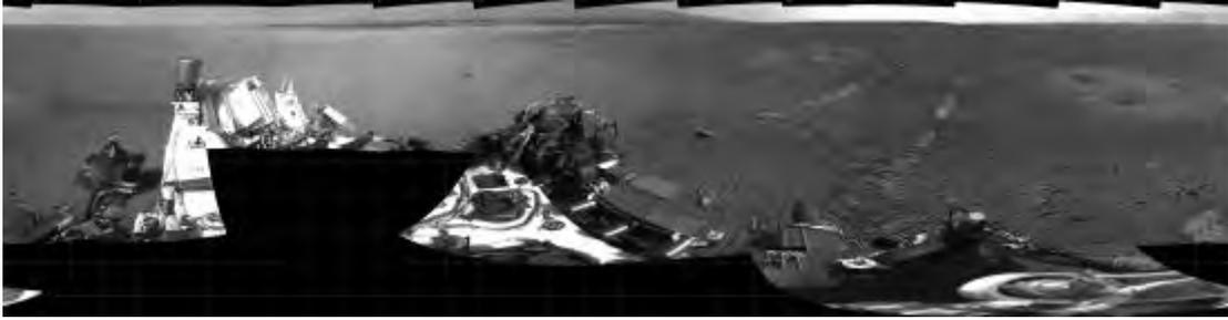
这一 360 度全景照片展示了好奇号首次测试行驶的情况。2012 年 8 月 22 日，好奇号首次尝试行驶，在此过程中好奇号向前行进了 4.5 米，转动 120 度，随后退后大约 2.5 米。目前好奇号已经离开它的着陆点大约 6 米。它的着陆点已经被命名为“雷·布莱伯利”
