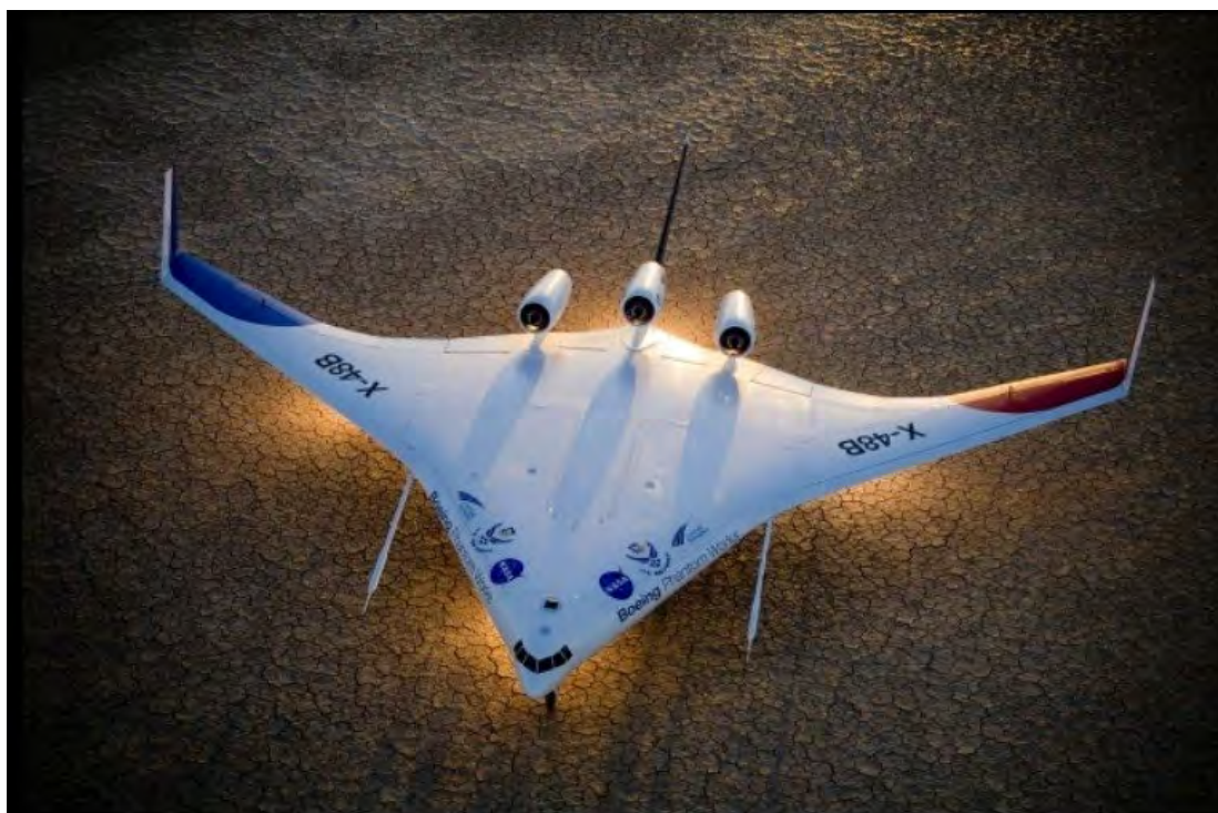
X-48 系列概念飞行器验证机采用了翼身融合的飞翼型布局
