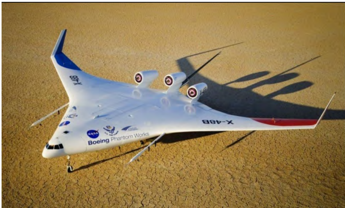
X-48B 采用了三台发动机布局和翼尖配备了小翼
