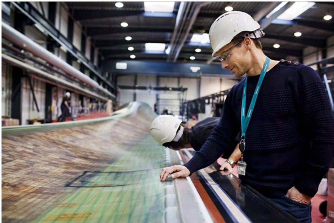
巨大的 B75 叶片制是光滑的流线型部件
