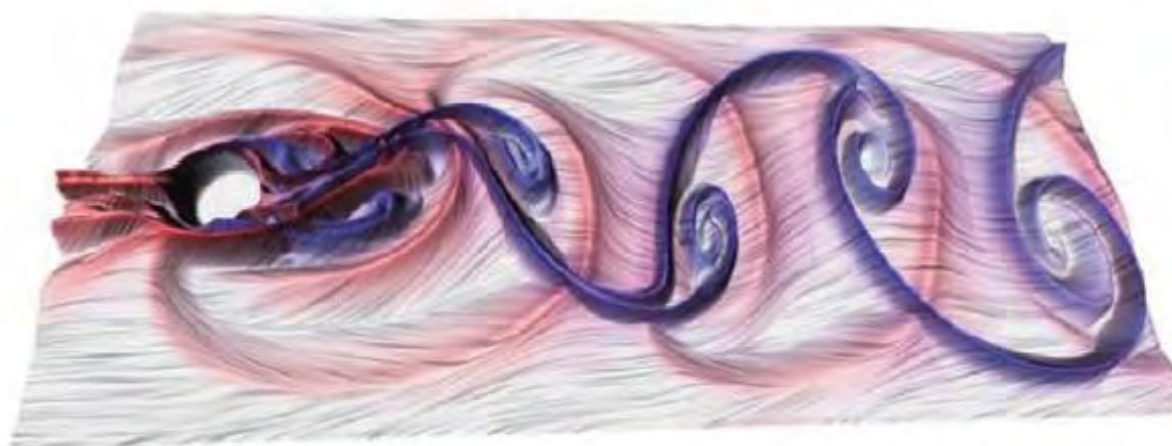
这幅电脑合成图片“冯·卡门涡街现象”是美国物理学会 2009 年度最佳流体运动图片作品展的获奖作品
