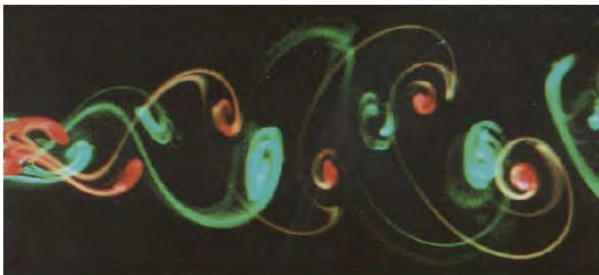
用 LIF (激光诱导荧光) 法拍摄的卡门涡街 (取自 Journal of Visualization 2001, VOL. 3 No. 4 封面)
