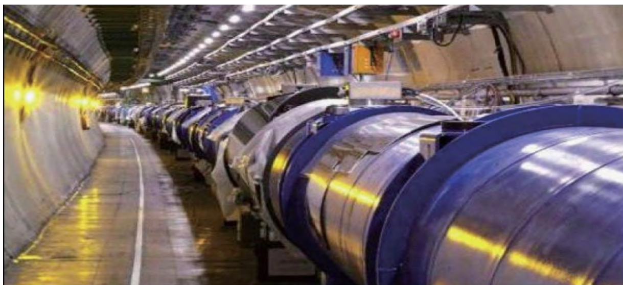
欧洲大型强子对撞机 LHC 上的高能粒子探测器和强制加速隧道，其中都用到了超导磁体。
