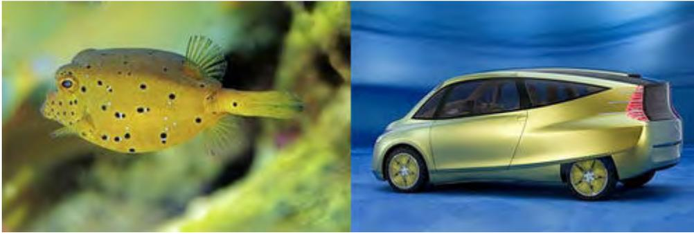
最近，戴姆勒·克莱斯勒汽车的设计师设计出了一款新型的概念车，造型就是模仿那种异乎寻常且其貌不扬的热带箱仔鲀。设计师将其命名为“仿生型车”，并实现了多年来一直追求的节能减排的梦想，即是成功减少 20% 的燃油消耗，以及降低 80% 的氮氧化合物的排放量。每加仑的柴油可以使这款车跑满 70 英里，同样这款车也可使用天然气或者生物柴油作为动力。到目前为止，这款车型已经遥遥领先于近期即将研发的所有概念车。
