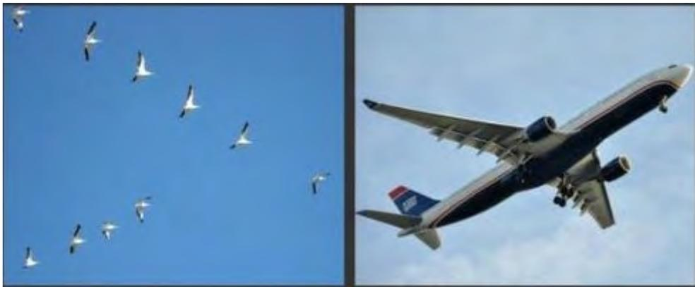
鸟儿采用V型飞行模式，可以增加70%的飞行距离。科学家研究发现，当鸟群采用熟悉的V形飞行时，第一只鸟儿拍动翅膀时，可以产生上升的气流，并为后面的鸟儿所用，从而可以增加飞行距离达70%。斯坦福大学的一组研究人员认为客运航空飞机采用同样的策略，比单独飞行减少15%的燃油量。
