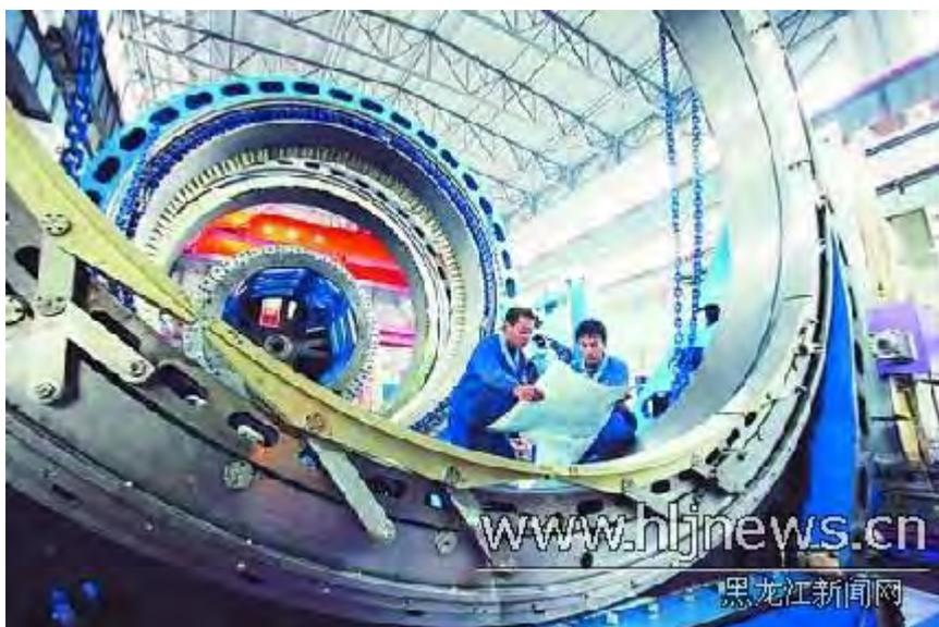
齐二机床为首都航天机械公司提供的 Z6350—373 型大运载火箭环缝总装焊接系统，目前已经进入最后的总装调试阶段。Z6350—373 型环缝总装焊接系统是一台集成了多种制造技术的超重型专用设备，可以使我国新一代运载火箭承载能力更大，射程更远，提升了我国的航天能力和国防实力。
