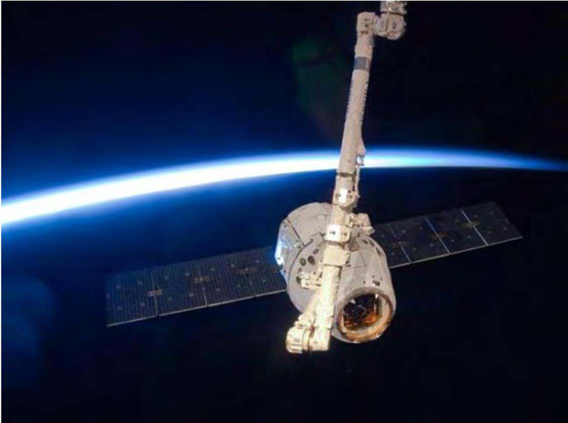
这张照片中，美国太空探索技术公司（SpaceX）的不载人太空飞船“龙”号正被国际空间站的机械臂牢牢抓住。
