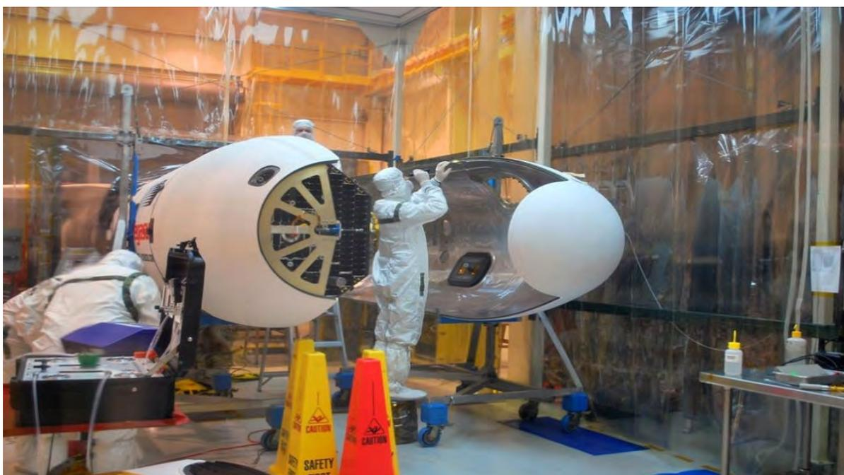
3 月 3 日，NuSTAR 望远镜已经被飞马座运载火箭整流罩包裹。
