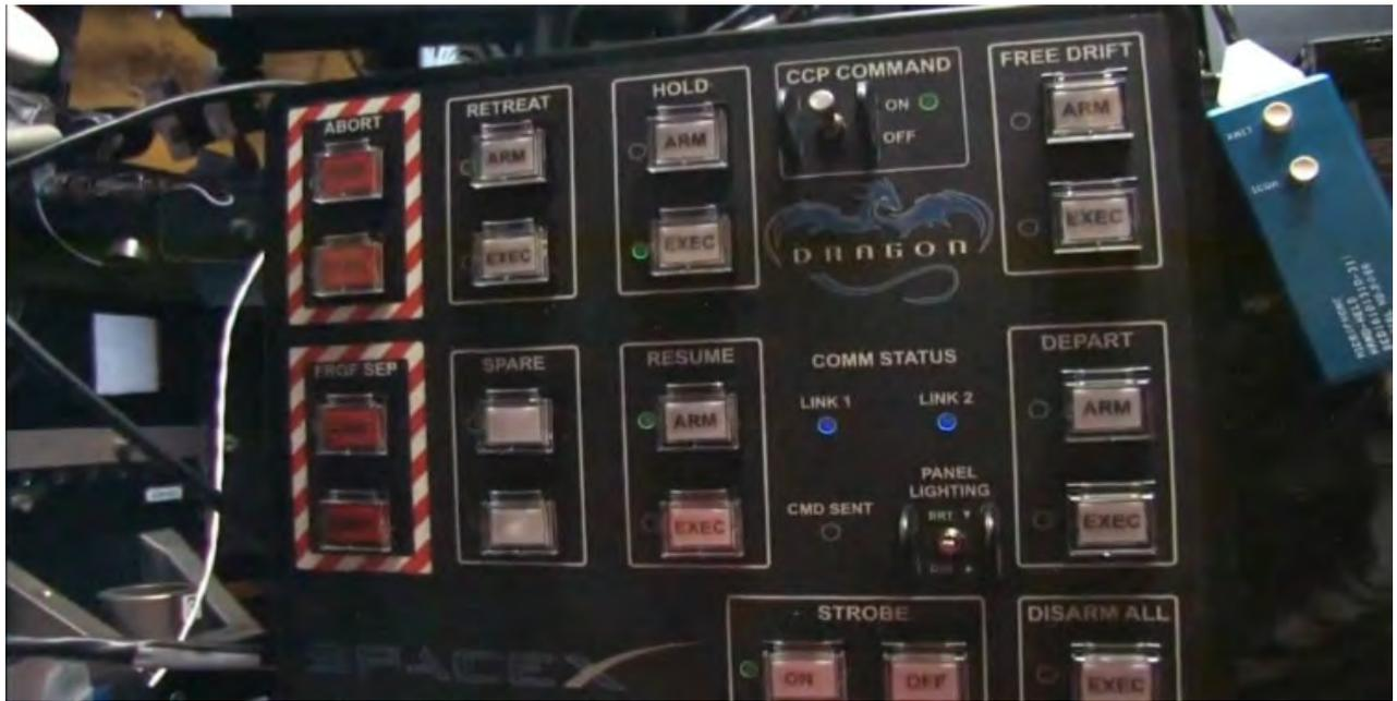
空间站上的 SpaceX 研制的龙式飞船特高频通讯控制单元，交会对接过程中航天员多次按下 HOLD 和 RETREAT 按钮
