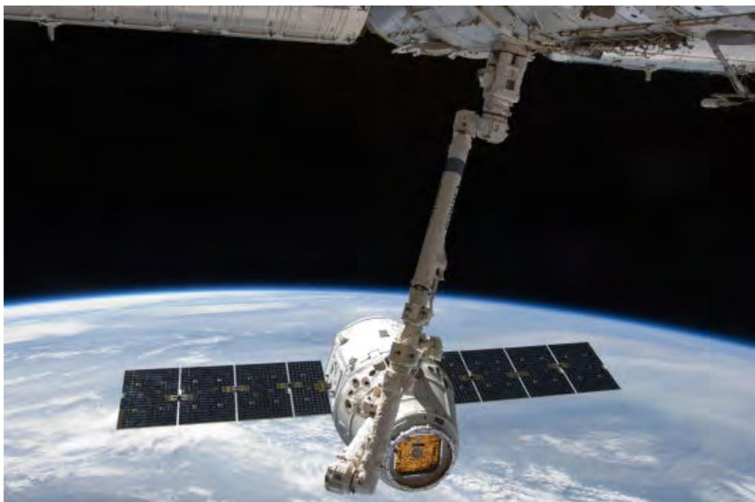
SpaceX 公司的龙飞船正逐渐接近国际空间站，以便空间站上的机械臂可以将其捕获并转移至相应的对接平台
