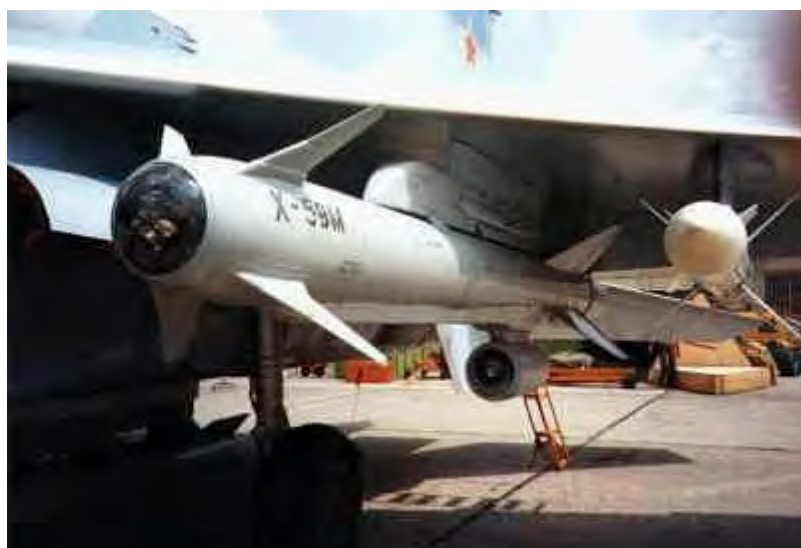
这张图片中的 Kh-59M，其安定面的后翼面已经展开
