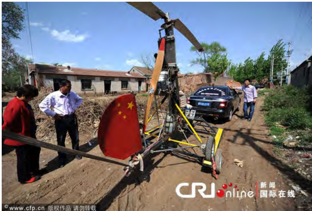
2012年4月25日, 河北省景县八里庄, 谢保刚试飞自己制造的旋翼式飞机。轿车拖飞机。
