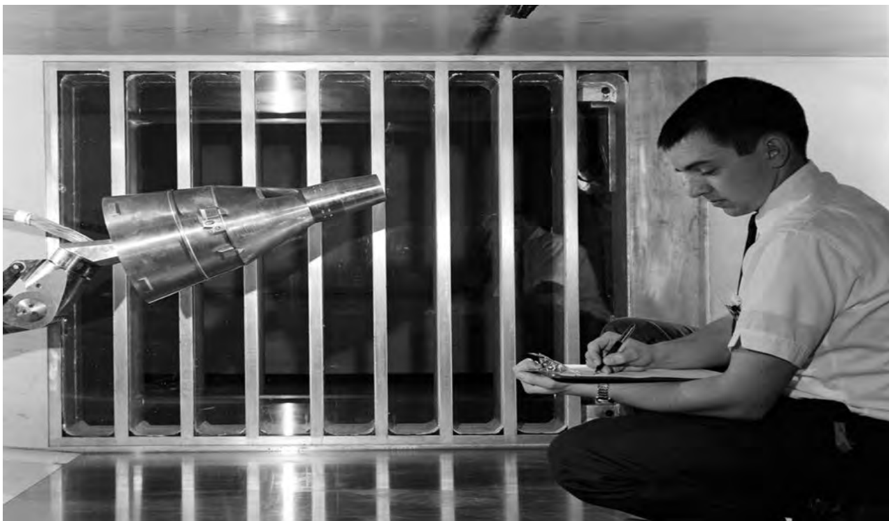
1962年11月7日，兰利研究中心的风洞，一个“双子座”太空舱模型正在接受测试。
