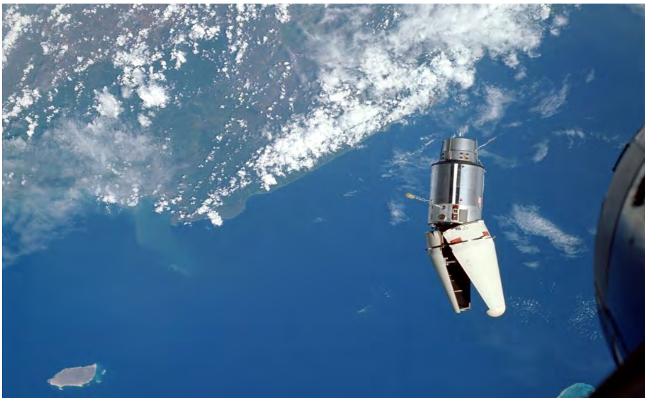
委内瑞拉托尔图加岛上空的“双子座 9A”号飞船，好似一条愤怒的鳄鱼。由于保护罩仍附在飞船上，“双子座 9A”号宇航员放弃与加力目标对接接合器对接。
