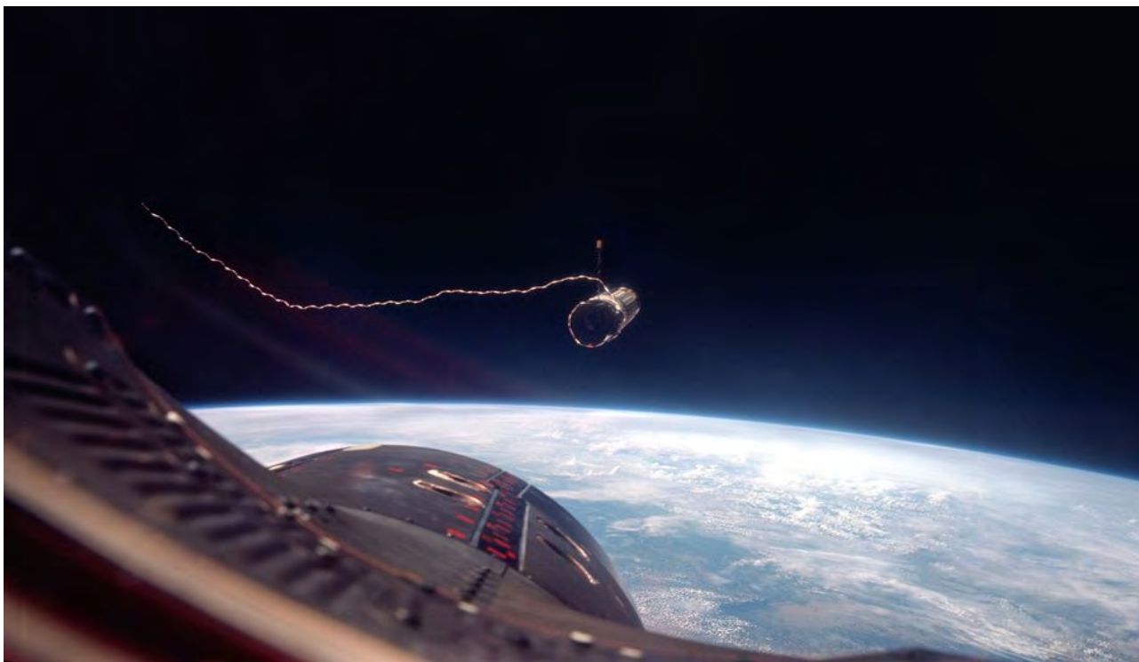
阿金纳目标飞行器借助绳索与“双子座 11”号相连。通过一条 50 英尺（约合 15 米）长的绳索连接两个飞行器并让它们发生旋转，宇航员能够制造出很小的人造重力。
