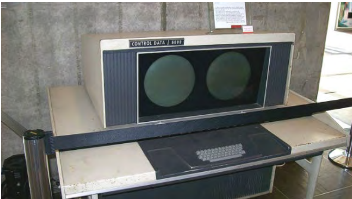
CDC 6600 被誉为世界上第一台超级计算机，由美国人西摩-克雷设计，1964 年完工。每秒浮点运算次数超过 100 万
