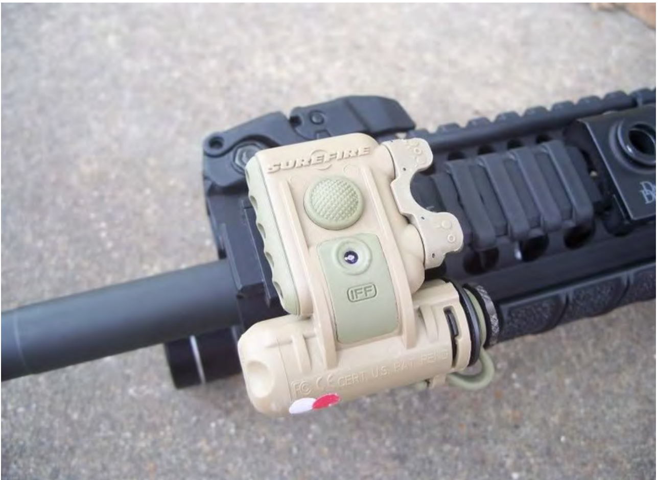
通过皮卡汀尼导轨，HL1 信号灯可以安装在步枪上
