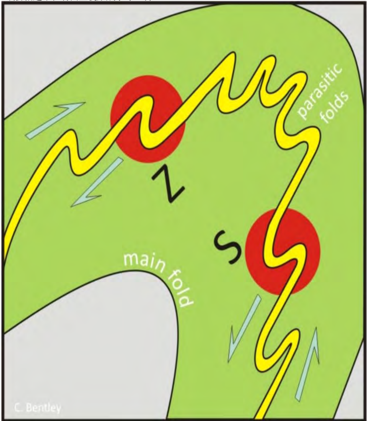
Pumpelly's Rule 图解（黄色层表示弱岩层，形成寄生褶皱）
