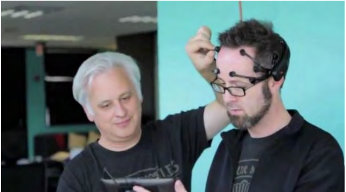
维特通过神经信号获取及处理头盔 Emotiv EPOC 把 Whurley 与滑板联系起来。这个平板电脑与用来驱动 800 瓦特发动机的软件进行无线连接
