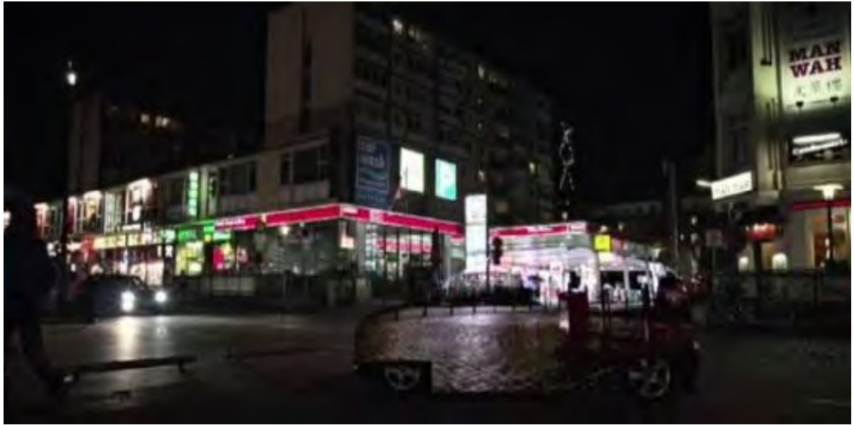
工程师让汽车驾驶者一侧覆盖上一层LED“毯子”，同时在另一侧安装数码SLR摄像机
