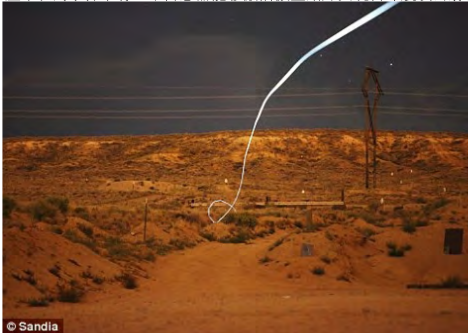
一个微型发光二极管附加在自导航子弹上显示共发光弹道路径
