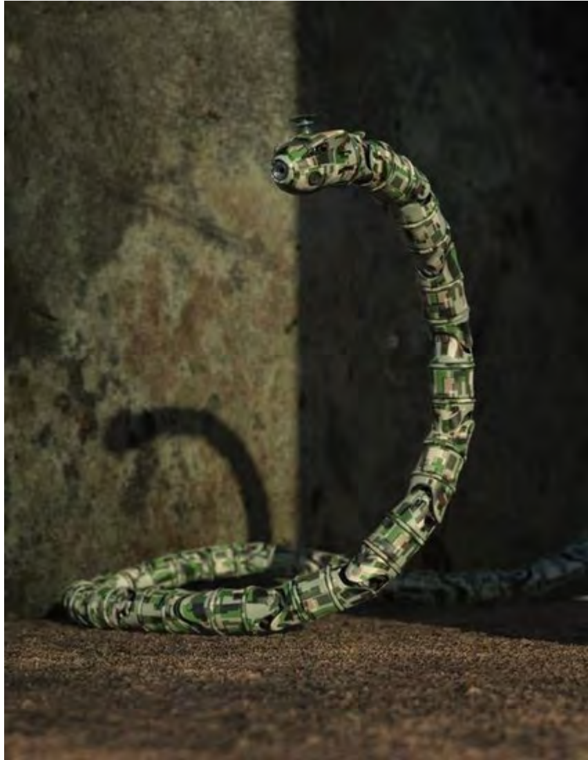
用于探测的蛇形智能机器人
