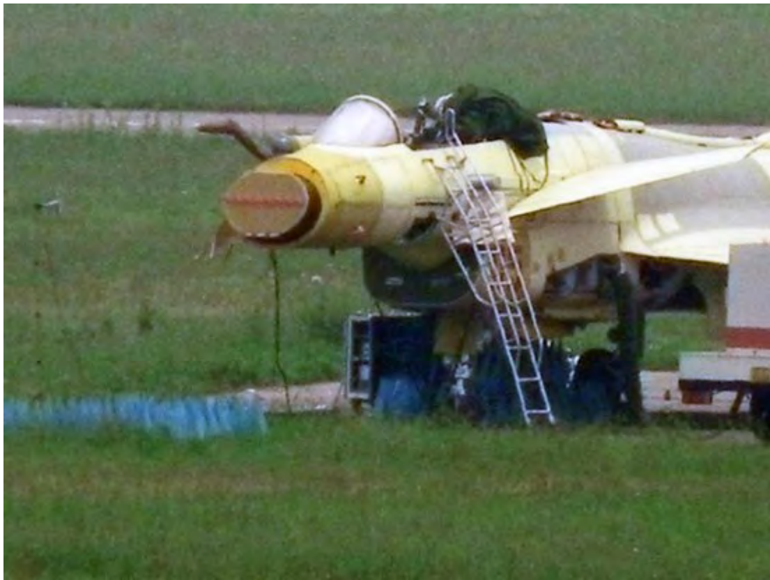
资料图：歼 10B 拆下机头整流罩露出机载雷达的照片
