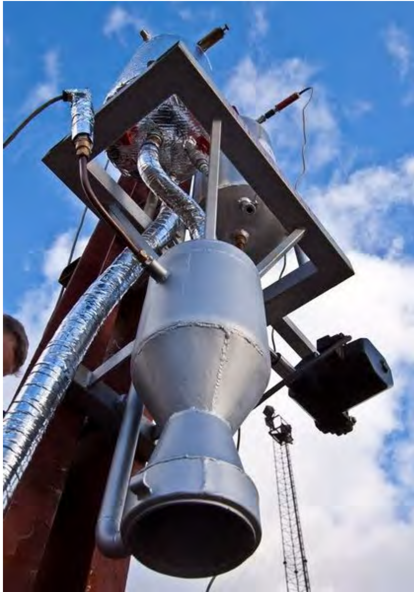
哥本哈根亚轨道公司制造的 XLR-3B 液体推进剂发动机。
