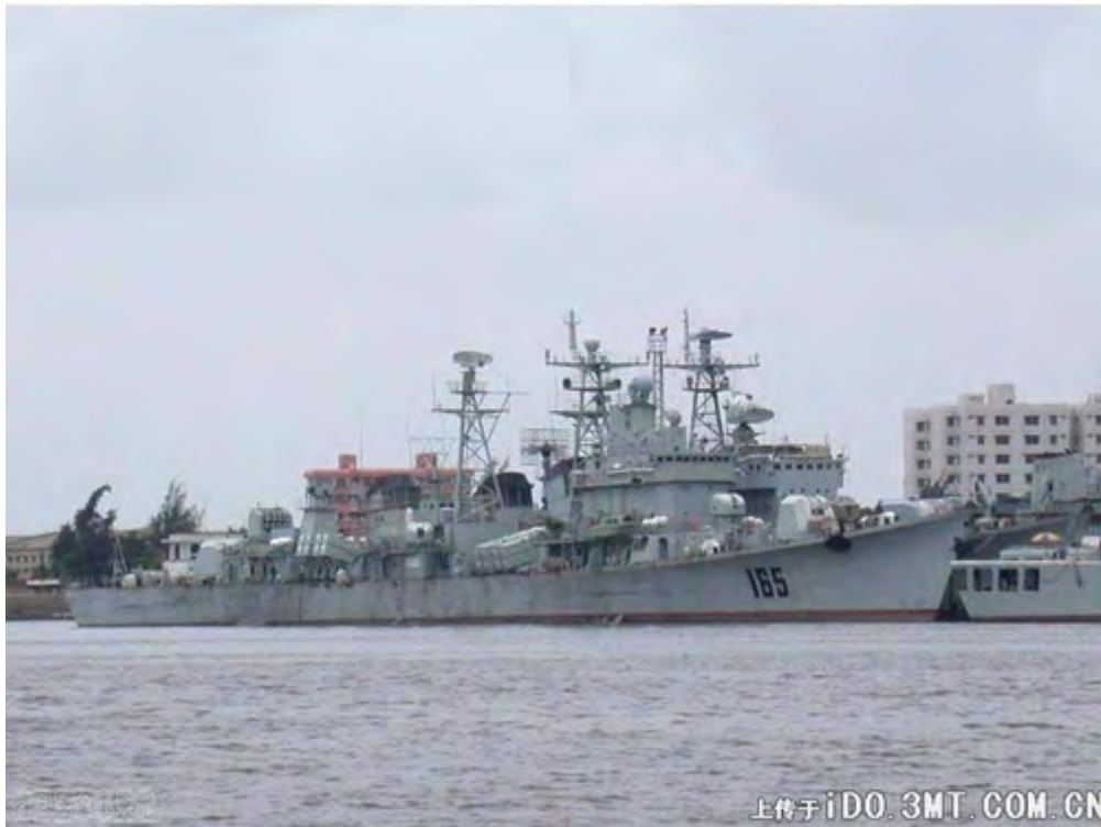
最新改进的旅大级，采用固定式四联装反舰导弹发射架
