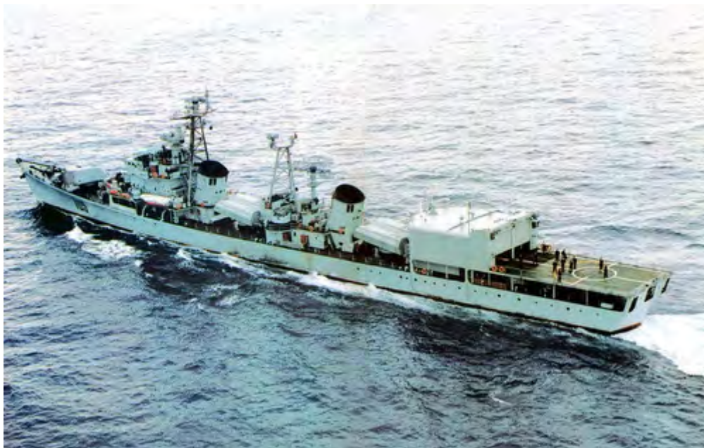
硕大的旋转式三联装导弹发射架是我国 051 型驱逐舰的最明显的外部特征
