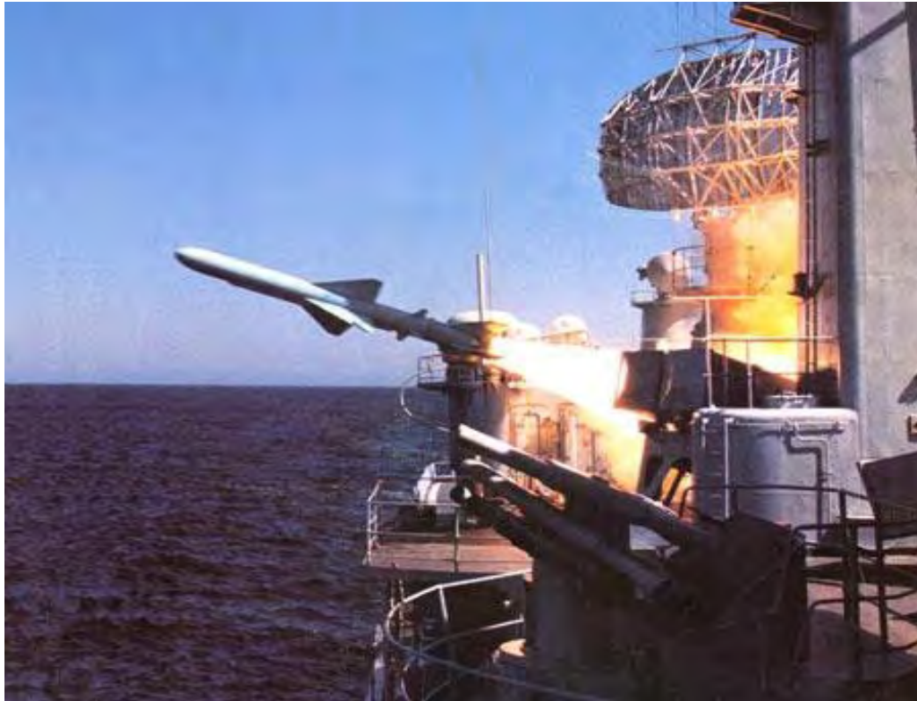
鹰击-8系列是我国第一种配备有惯性制导系统的反舰导弹
