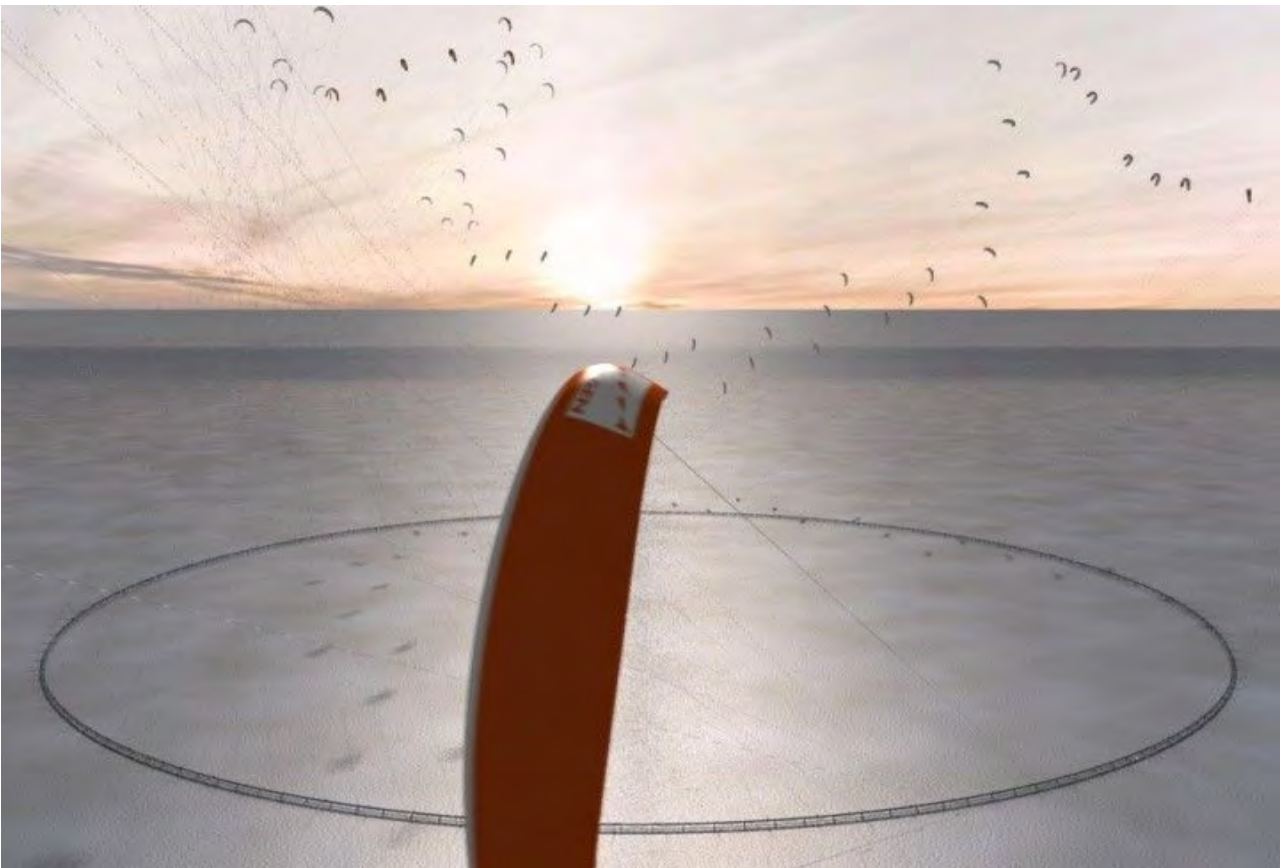
KiteGen 公司设计的可发电的巨型旋转木马，一般安装在近海处。（概念图）
