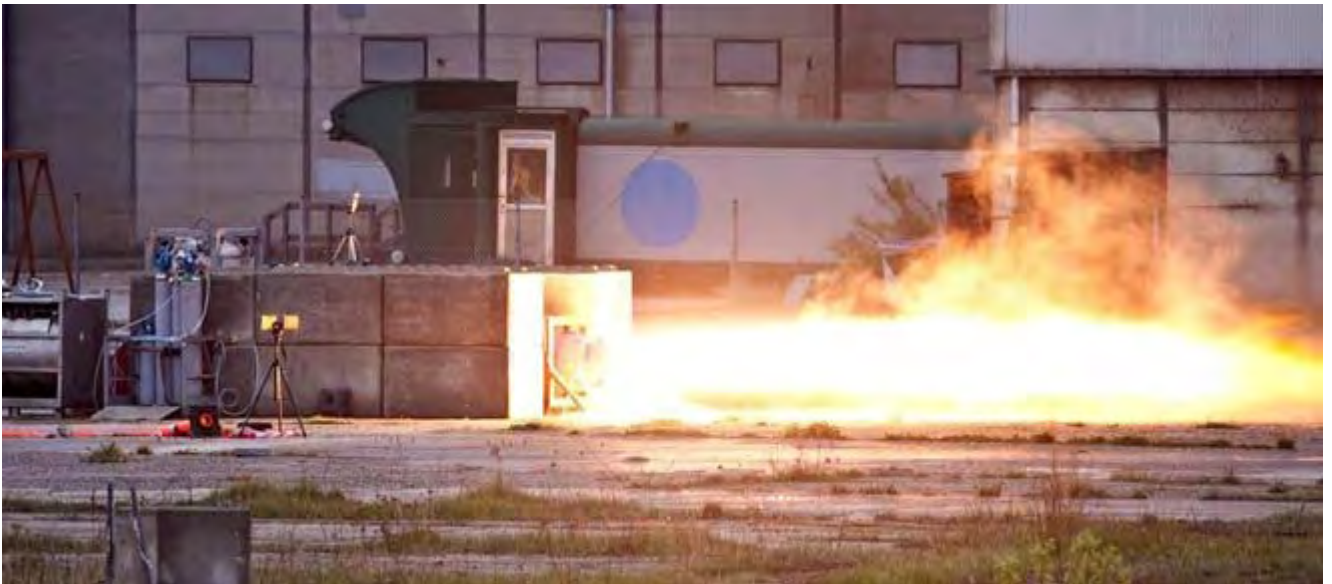
HEAT1X 混合动力火箭发动机接受静态测试。
