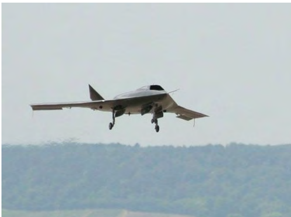
采用飞翼和机背进气道布局的RQ-170，具备较高的隐身能力
