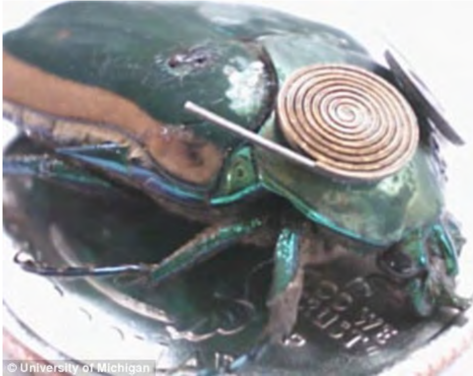
一只绿色六月鳃角金龟，装有微型动能发电机，用于满足所携带的微型摄像头和麦克风的用电需求
