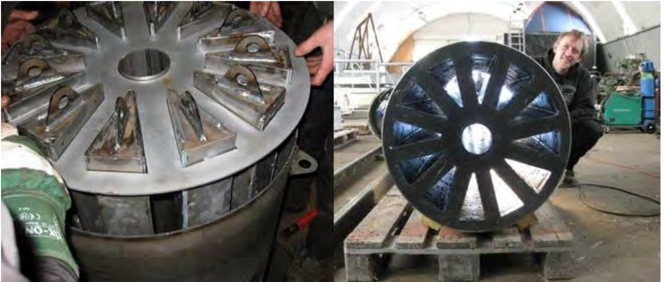
HEAT1X 发动机药柱，采用聚氨酯橡胶打造。
