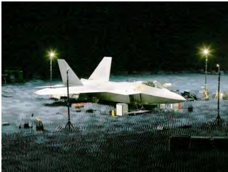
在微波暗室进行电子系统测试的F-22战斗机。
