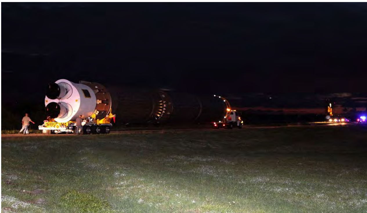
2011年9月8日，“宇宙神”V型火箭的第一级离开卡纳维拉尔角空军基地的宇宙神太空飞行操作中心。联合发射同盟的“宇宙神”V-541型火箭负责将“好奇”号送入太空。
