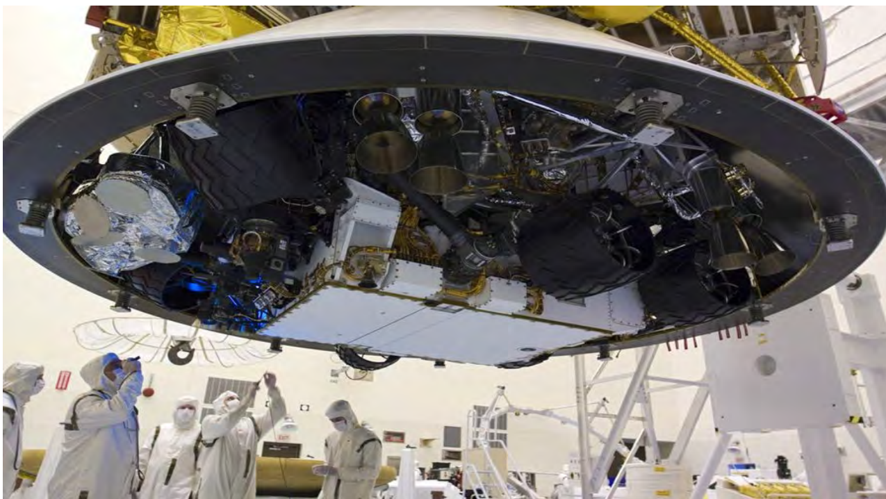
肯尼迪航天中心的危险载荷整备设施，技术人员站在“好奇”号下面，检查减速伞。减速伞与巡航级连接在一起。
