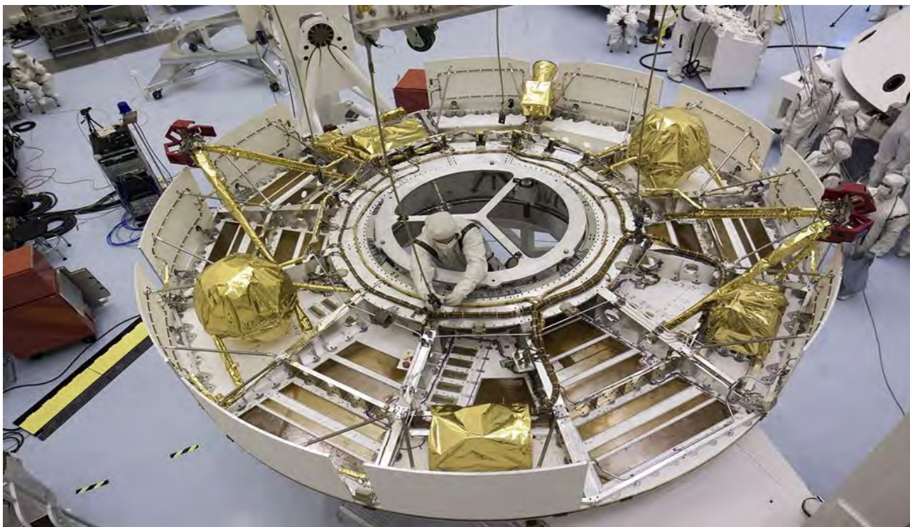
2011年10月，在将巡航级吊到旋转台上后，技术人员拆掉巡航级上的吊索。巡航级装有太阳能推进器，负责为“好奇”号进行导航；同时装有热交换器，用于“好奇”号在地球到火星的9个月飞行途中进行热交换。
