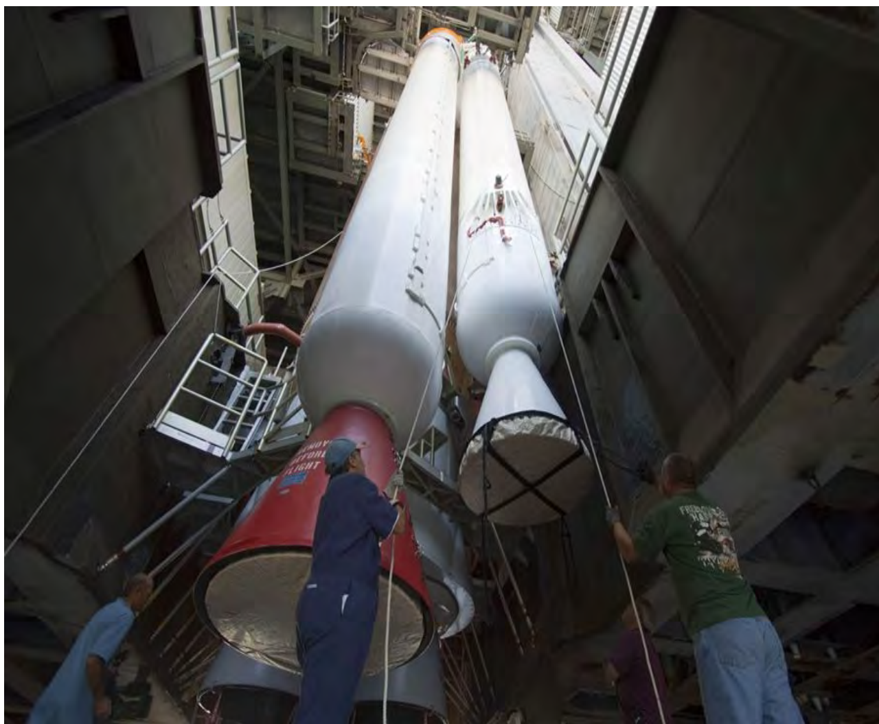
卡纳维拉尔角空军基地 41 号发射架的垂直整合设施内部，技术人员利用高架起重机将固体火箭发动机吊到指定位置，与联合发射同盟的“宇宙神”V 型火箭的第一级相连。2011 年 11 月 26 日，这枚火箭搭载“好奇”号发射升空。
