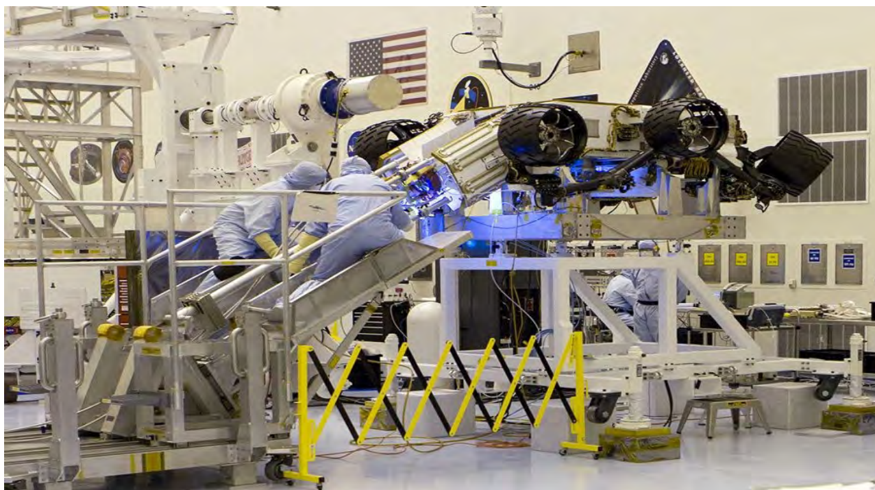
肯尼迪航天中心的危险载荷整备设施，技术人员将 MMRTG 发电机装上倒置的“好奇”号，进行密合度检查。检查结束后，技术人员拆下 MMRTG。在发射架上，MMRTG 将重新安装到“好奇”号上。
