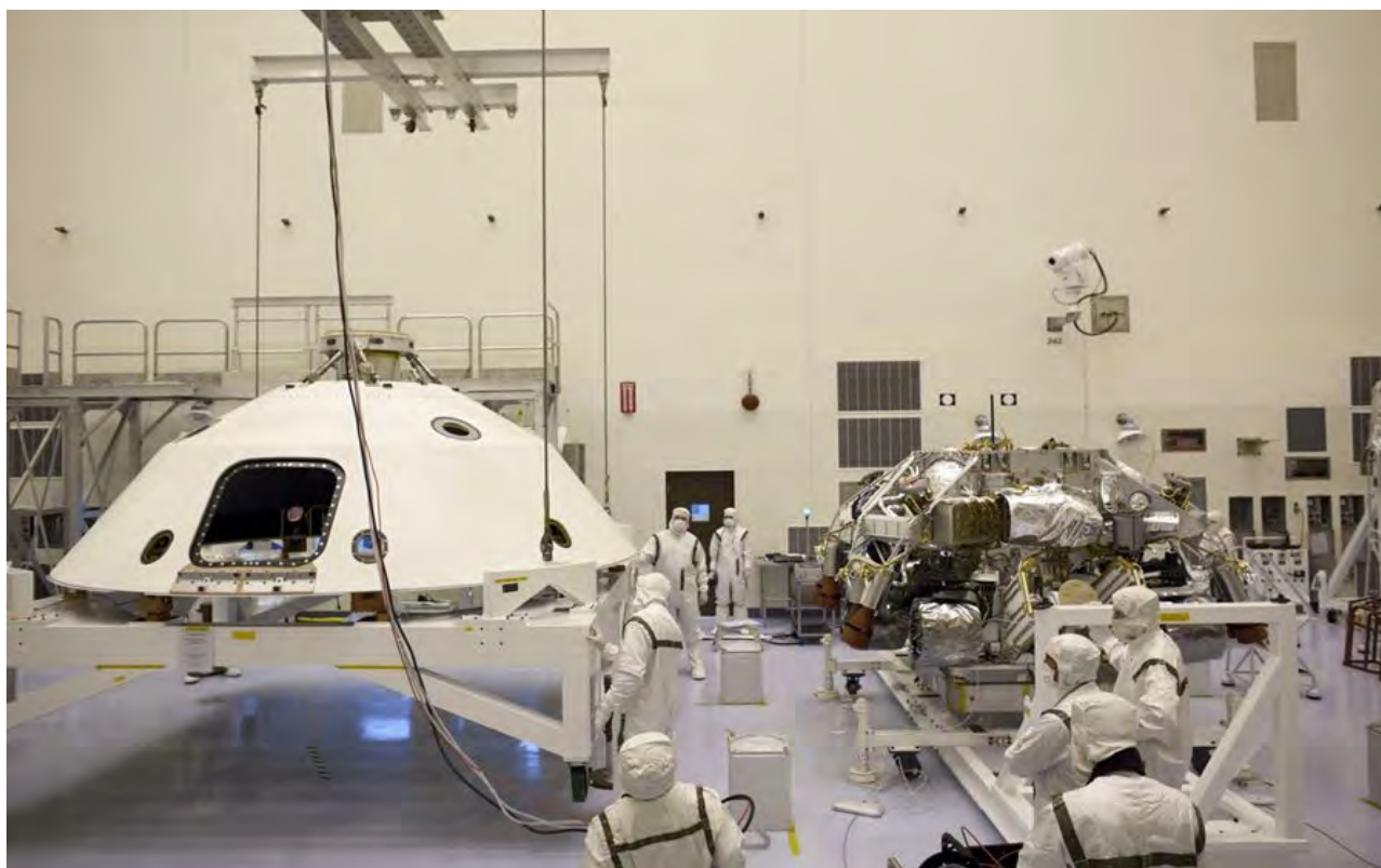
宇航局的肯尼迪航天中心，技术人员利用桥式起重机吊起“好奇”号的后壳。这个壳结构是一个保护罩，携带减速伞和其他用于进入、降落和着陆过程最后阶段的装置。右侧的“好奇”号和火箭动力下降级将被装进后壳。
