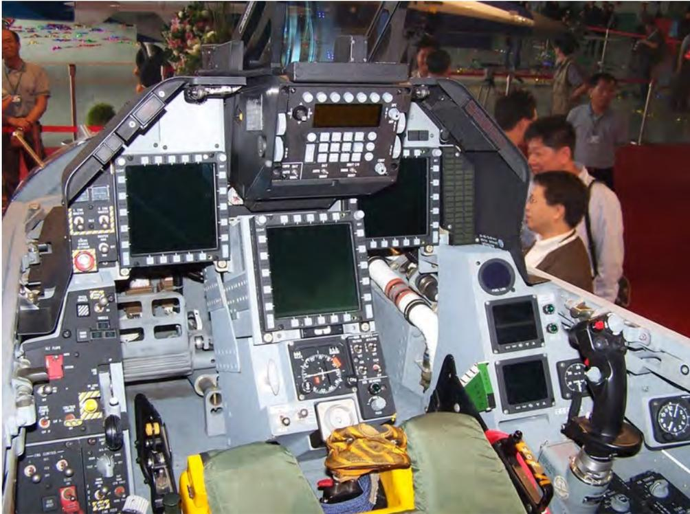
IDF 采用第三代交联航电系统，比当时大陆采用的平显为核心的分立式航电要先进一代，改进型更是采用一平三下座舱设计。
