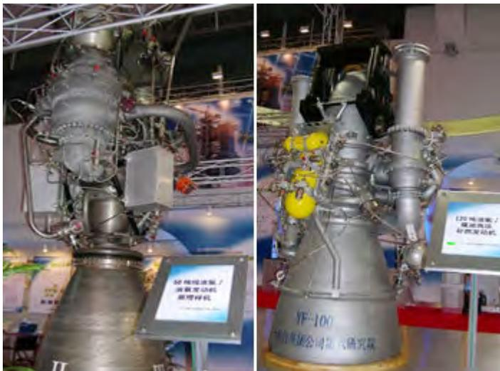
长征 5 号火箭将使用的 50 吨级 YF-77 氢氧发动机 (图左) 和 120 吨级 YF-100 液氧煤油发动机 (图右)。这将可让长征 5 号的推力水平达到国外主流运载火箭的水平。
