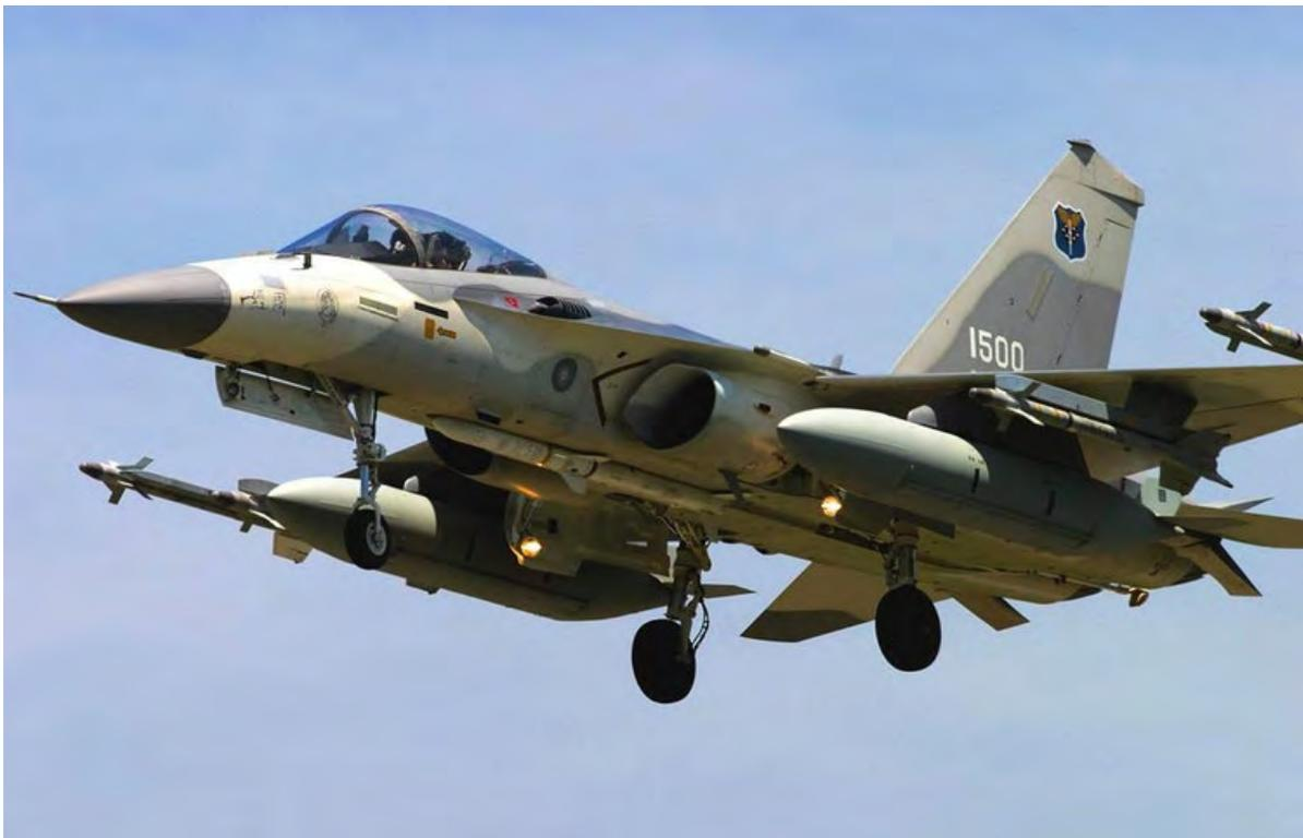
根据该图可以看到，IDF的翼尖和主翼外侧挂架是基本无法挂载体积较大的“天剑-2”空空导弹的，基本上只能挂载格斗导弹。
