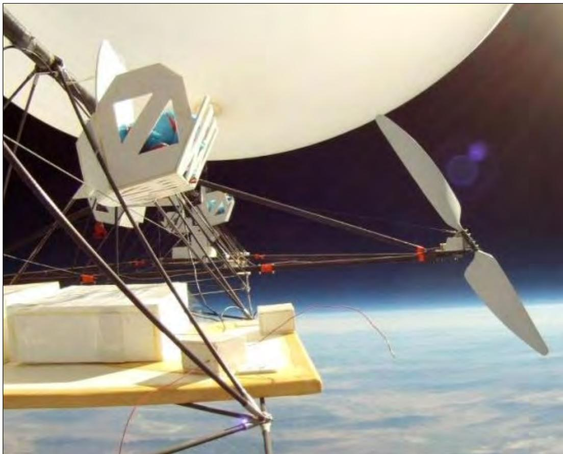
大气飞艇其实是一个 30 英尺(约合 9 米)长的碳结构机身，上面绑有一前一后两个气球。
