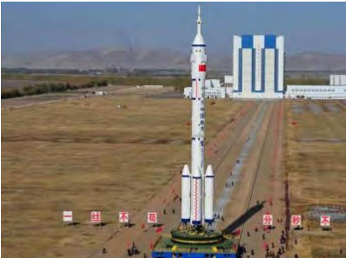
正在向发射架转运中的神舟八号飞船与长征2F火箭的综合体。长征2F火箭在所有中国火箭中可靠性指标最高。
