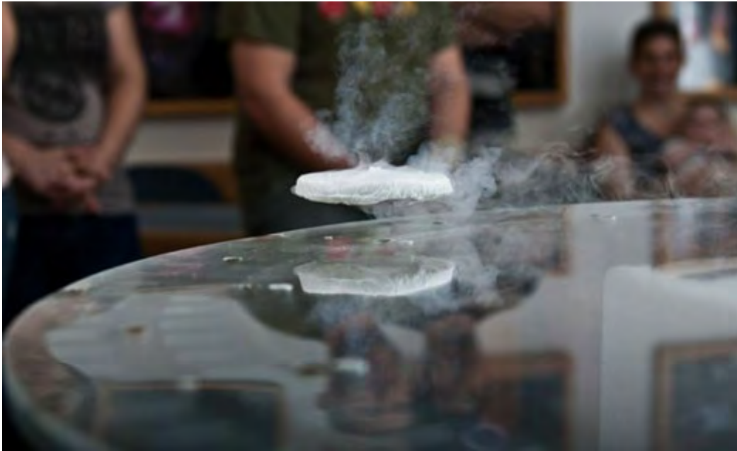
钇钡铜氧这样的高温超导体在实际应用中可用作核磁共振成像、磁悬浮设施
