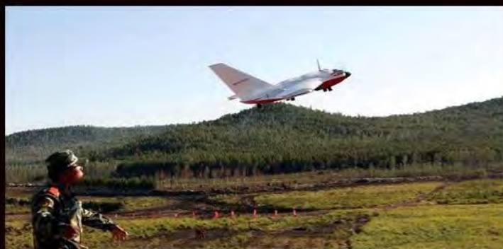
图为2011年8月23日，武警森林部队成功举行“绿色卫士-11”灭火实兵演习。演习中，展示了小型无人机等试验性侦察装备。据介绍，小型无人机用来远程接收侦察实时视频信息，主要用于森林巡护、火场验收及航拍定位。
