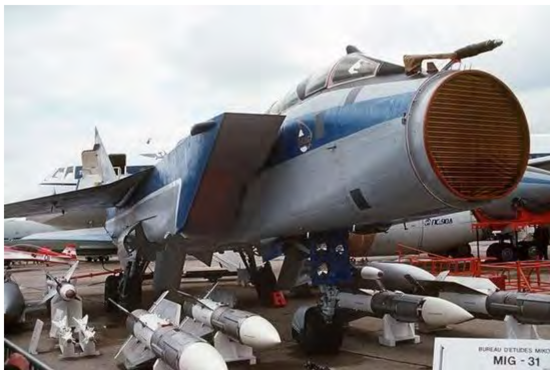
米格-31M 机腹保形外挂点所携带的 P-37（英文代号 R37）远程空空导弹。
