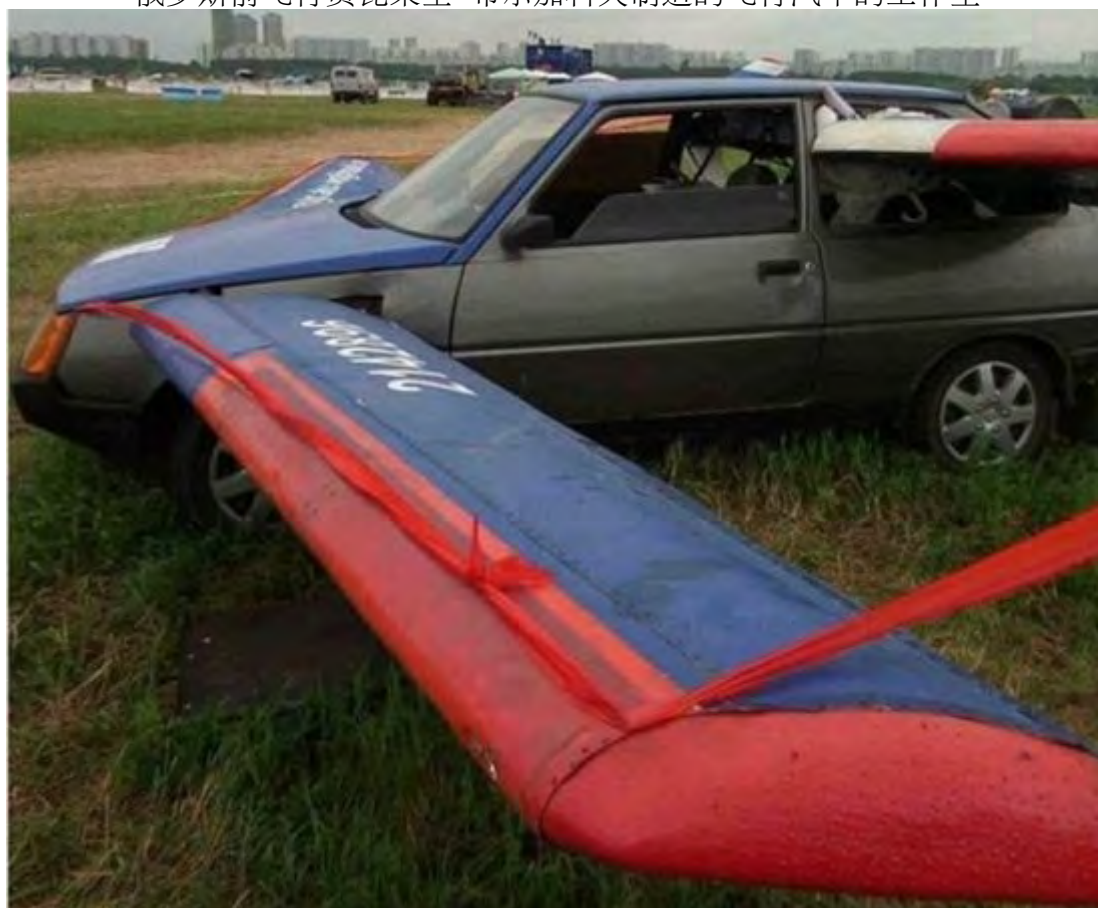
这辆飞行汽车通过对 1987 年出产的 ZAZ Tavria 进行改装并安装机翼而成
