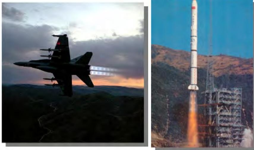
超声速喷气飞机和长征火箭尾喷管形成的激波及其反射
