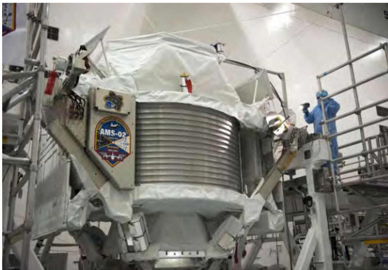
在“奋进”号航天飞机即将发射之前，工程师们正在对反物质太空磁谱仪实施最后的检测。反物质太空磁谱仪将在国际空间站上探测宇宙射线。
