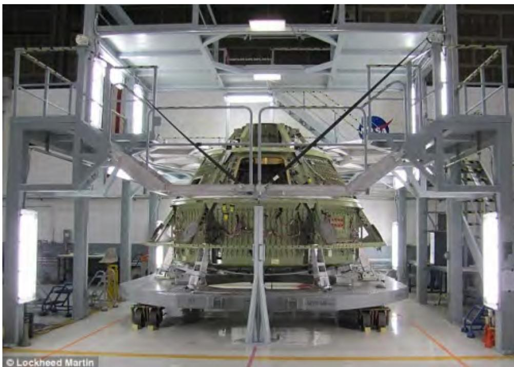
外部尚未涂上陶瓷涂层的太空舱，内部设备装置齐全
