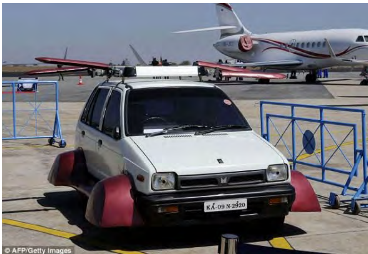
“飞行的马鲁蒂”车顶部装有旋转叶片，四个车轮均有一个向外延伸的真空装置
